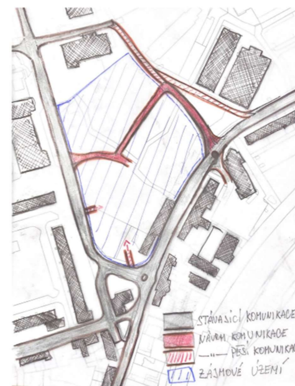
Obr. 60 - Skica dopravního řešení v areálu
