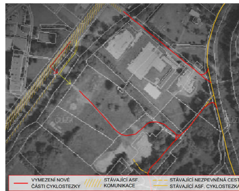
Obr. 107 - Konceptní schéma napojení nové části cyklostezky
