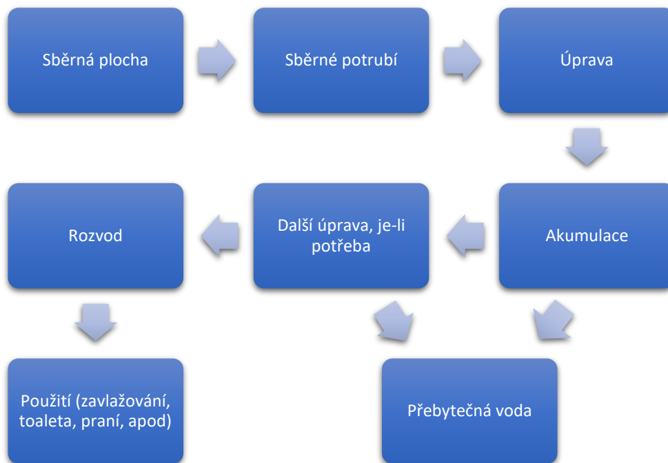
Obr. č. 2: Zjednodušené schéma hospodaření se srážkovými vodami převzaté z evropské normy ČSN EN 16941-1 [13]
