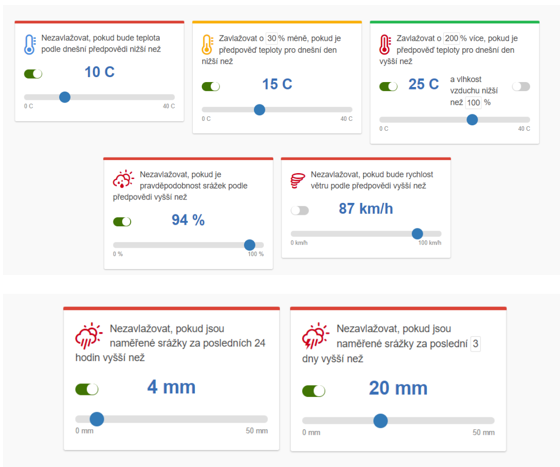
Obr. č. 47: Nastavení automatických korekcí na experimentálních plochách při využití metody závlahového intervalu
