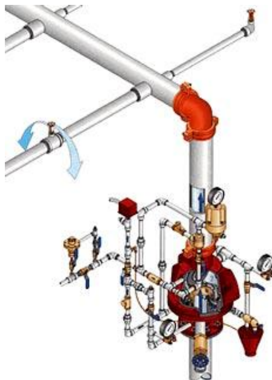
obr. 11 Suchá ventilová stanice [10]
