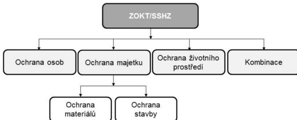
obr. 30 Základní důvody instalace ZOKT a SHZ [23]
