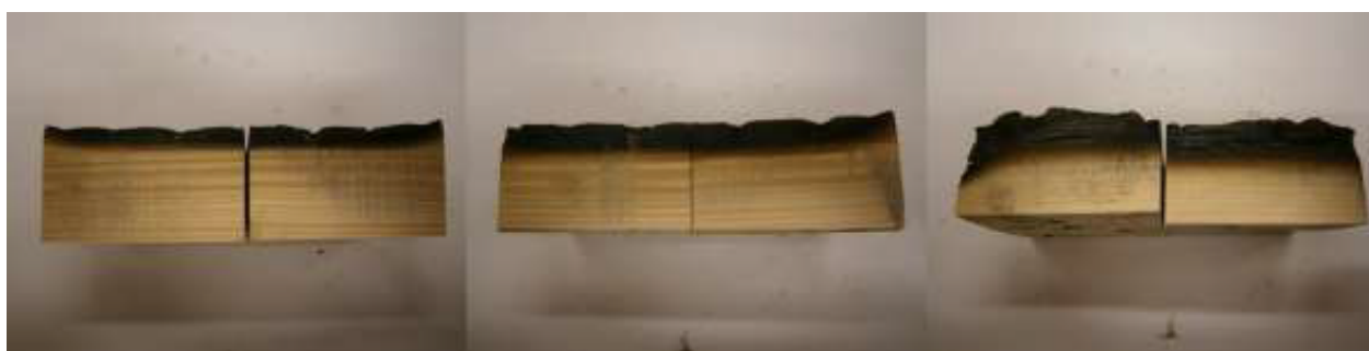
Obr. 4: Hloubka zuhelnatění vzorků smrku při působení tepelného toku 25 kW/m 2 . Doby expozice vzorků jsou zleva: 10, 15 a 20 minut
