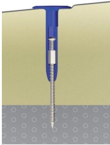
Obr. 11 - kotva do tepelné izolace [11]
