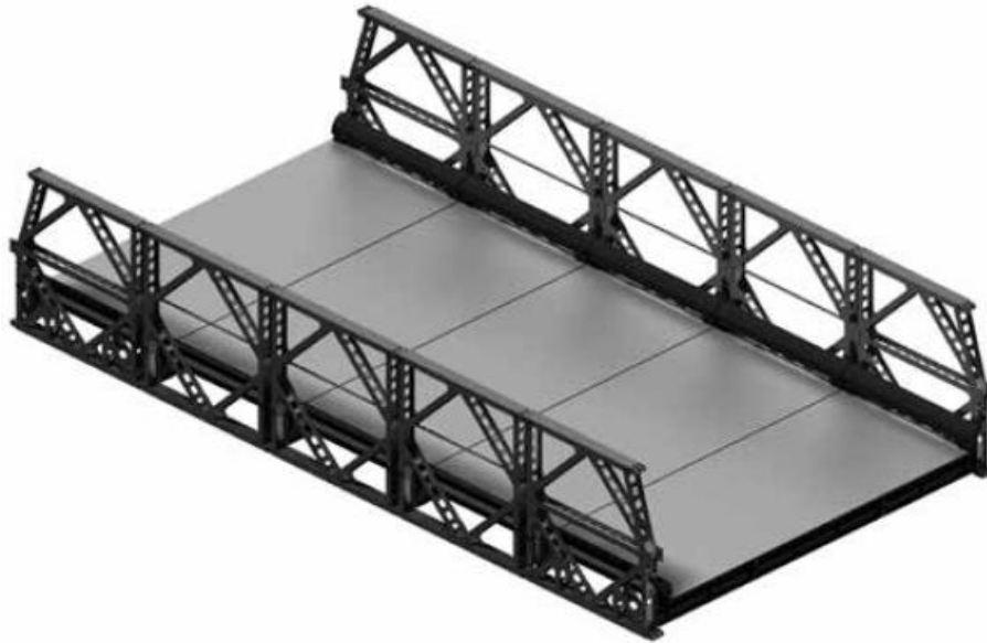
Obrázek 5 MMT - Montovaný most tylový [1]
