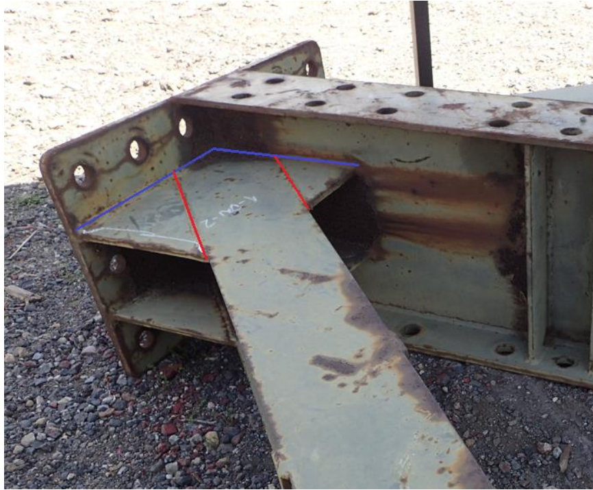
Obrázek 92 Element - únavové detaily [9]
