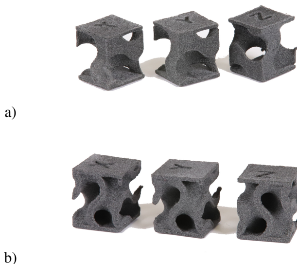
Obrázek 8.7: Výsledná testovací tělesa s roznášecími podstavami v rozdílných rovinách. a) trabekulární gyroidní struktura, b) stěnová gyroidní struktura
