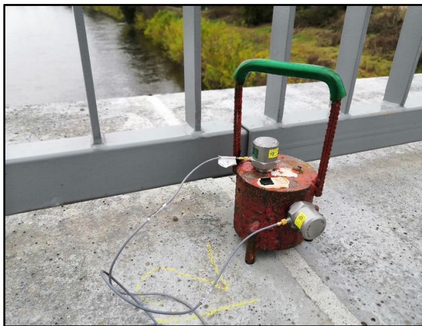
Obr. 20 Dva snímače zrychlení Brüel&Kjaer 8344 připevněné magnetem k ocelovému závaží při dynamické zatěžovací zkoušce
