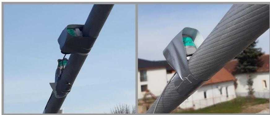
Obr. 24 Umístění snímačů zrychlení na závěsech
