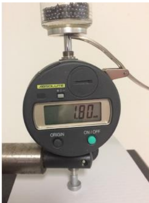
Obr. č. 47 – Mechanické zařízení pro měření tloušťky fólie (čtení na přístroji 1.8 mm) (31)
