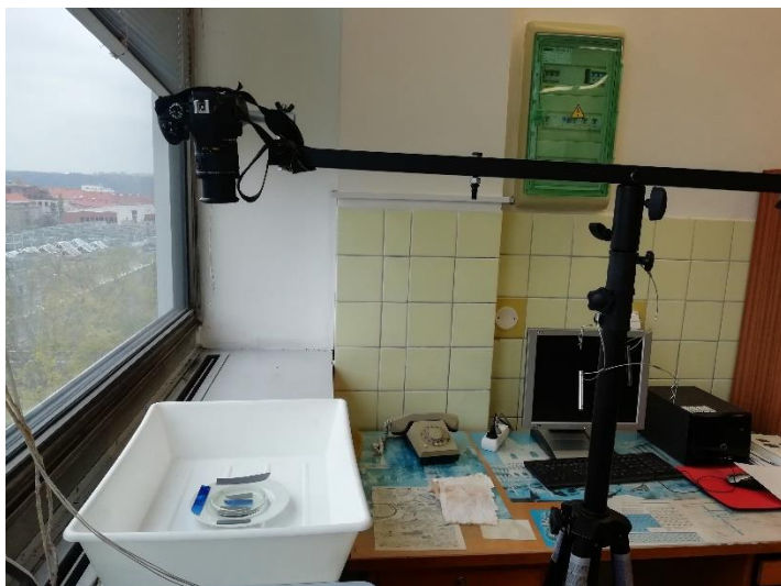
Obr. č. 79 – Aparatura dokumentace postupu blednutí
