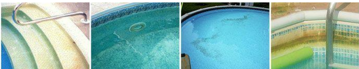
Obr. č. 34 – Příkladů vzniklých skvrn na povrchu bazénové fólie; blog.intheswim.com (24)
