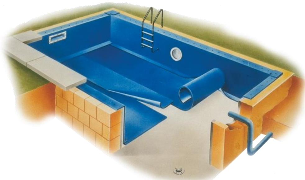
Obr. č. 21 – Ukázka pokrytí bazénu těžkou fólií; natare.com, PVC pool lining
