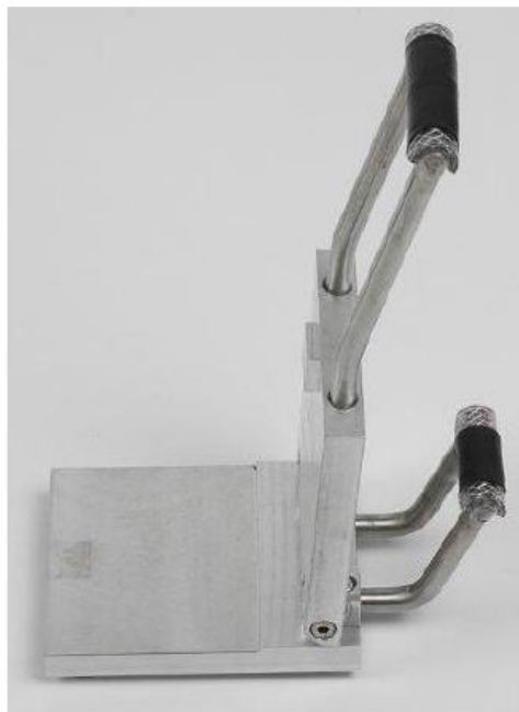
Obr. č. 52 – zkušební přístroj pro definici ohebnosti za nízkých teplot (38)
