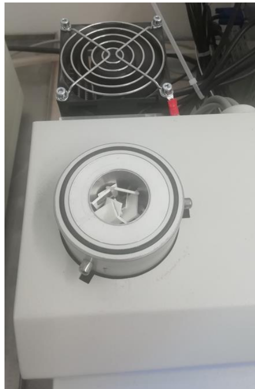
Obr. č. 61 a 62 – Aparatura héliového pyknometru (vlevo); Naplněný kalíšek umístěný v přístroji (vpravo)
