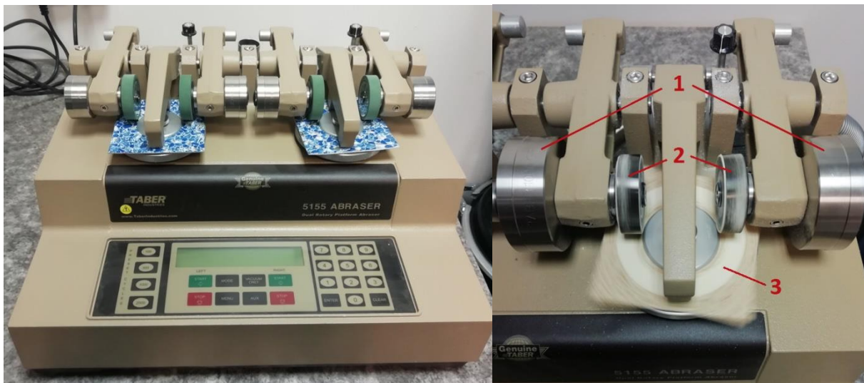
Obr. č. 71 a 72 – Abrasní přístroj (vlevo); Rotační souprava testovaného vzorku (vpravo)
