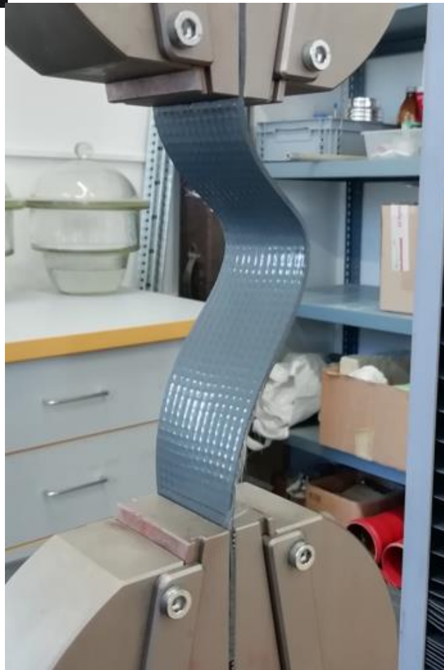
Obr. č. 67 a 68 – Místo porušení vyztužení fólie (vlevo); Stav fólie při vrácení čelistí do počáteční polohy po provedeném testu (vpravo)
