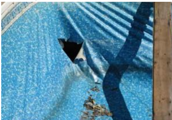
Obr. č. 16 a 17 – Poškození: protržení fólie (vlevo), rolování špatně napnuté fólie (vpravo); uvpools.com, damaged pool liner; poolspanews.com
