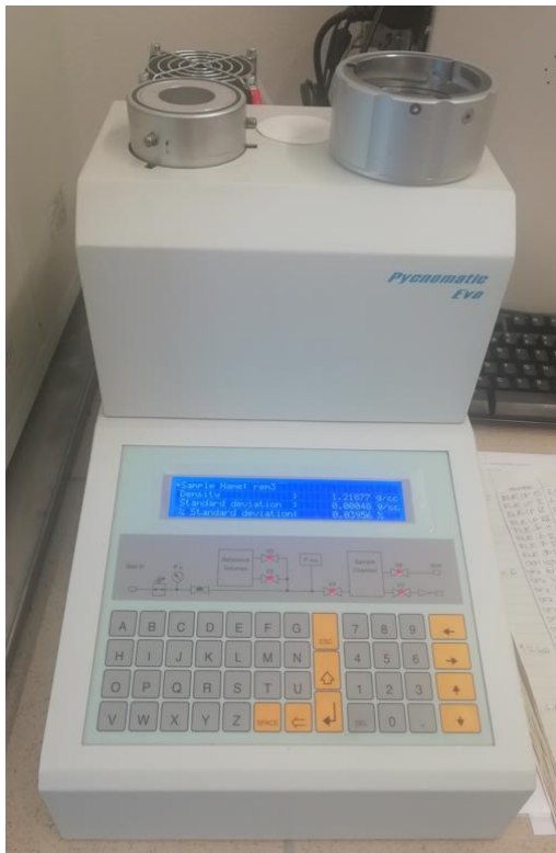
Obr. č. 61 a 62 – Aparatura héliového pyknometru (vlevo); Naplněný kalíšek umístěný v přístroji (vpravo)
