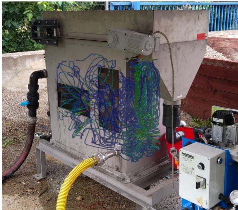
Obr. 59 Znárodnění proudnic uvnitř jednotky skrz brýle Microsoft HoloLens
