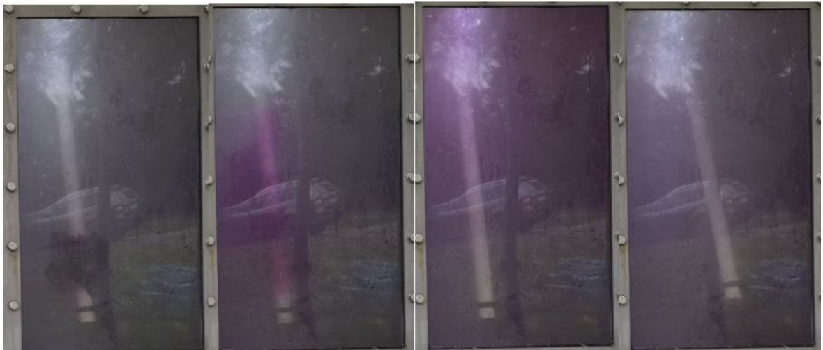
Obr. 61 Vstříknutí manganistanu draselného nad mikrobublinným generátorem
