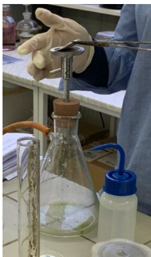
Obr. 22 Odstranění kalového koláče z filtračního nástavce
