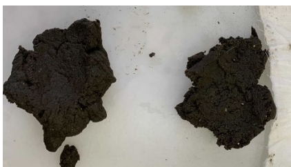
Obr. 56 Porovnání výsledku squeeze testu s výsledným kalovým koláčem ze stroje
