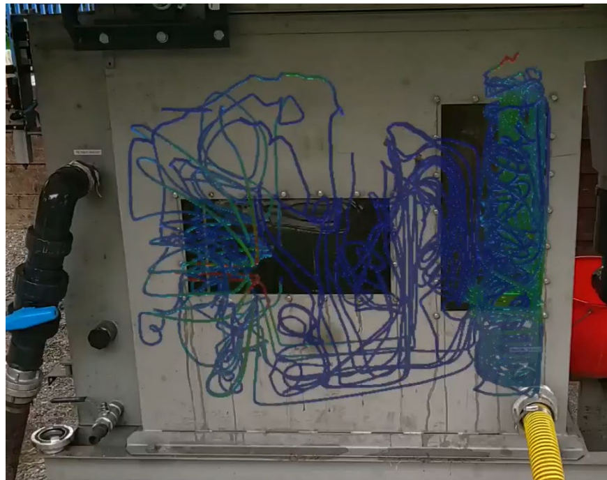
Obr. 62 Znáznornění proudnic uvnitř jednotky skrz brýle Microsoft Hololens
