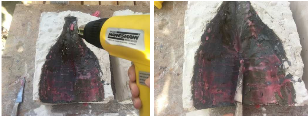
Obrázek 8.1. Potahování formy voskem
