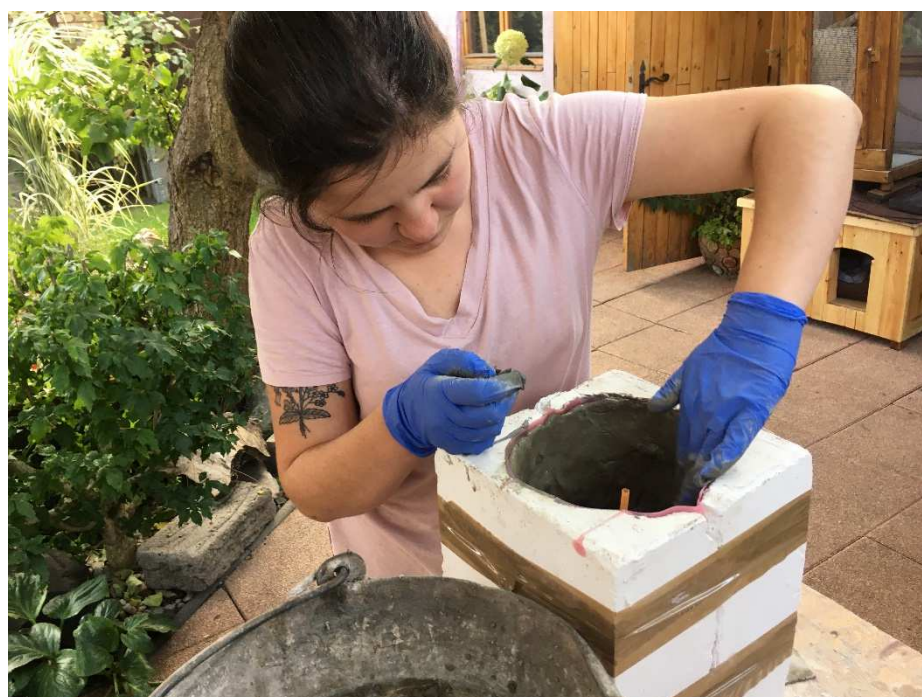
Obrázek 8.8. Proces betonáže stínidla
