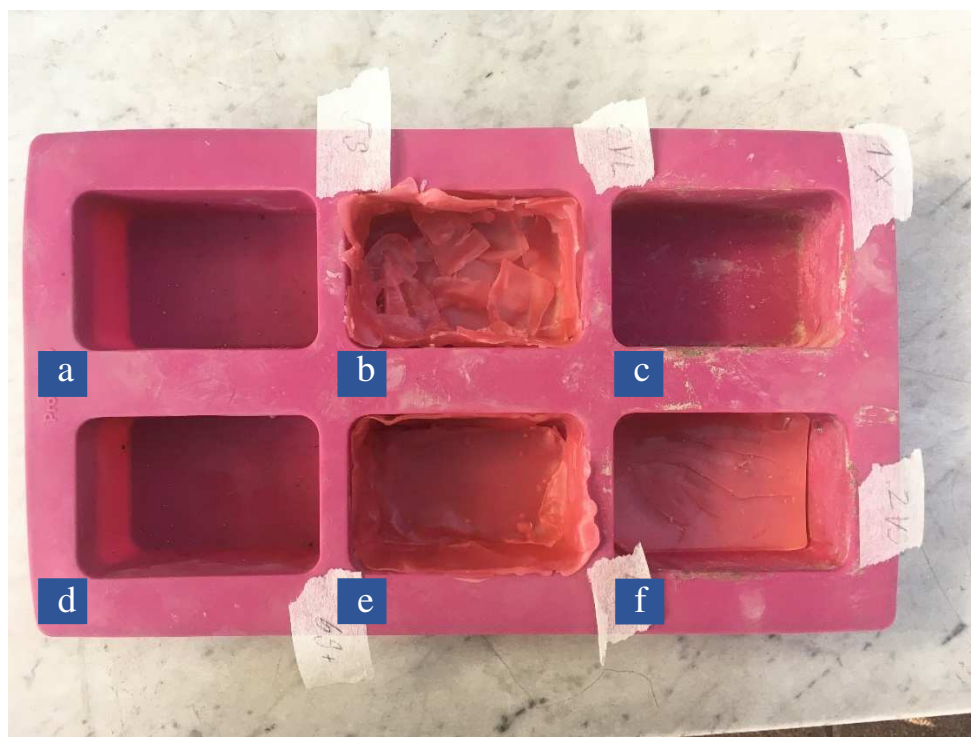
Obrázek 7.3: Silikonová forma s povrchovými úpravami před betonáží vzorků
