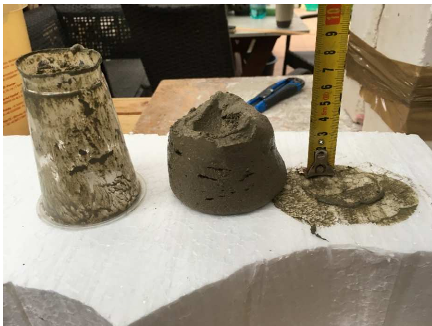
Obrázek 8.6. Zjednodušená zkouška sednutí
