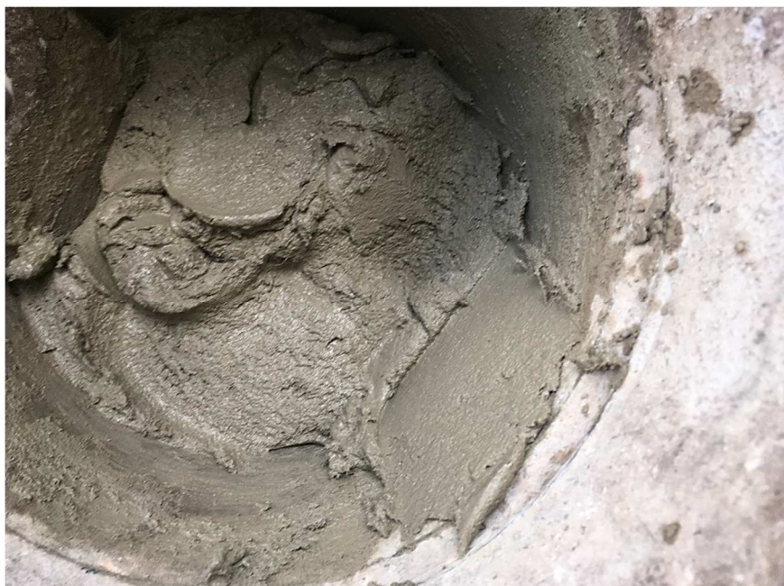
Obrázek 6.1. Zkouška přilnavosti směsi na stěně kyblíku
