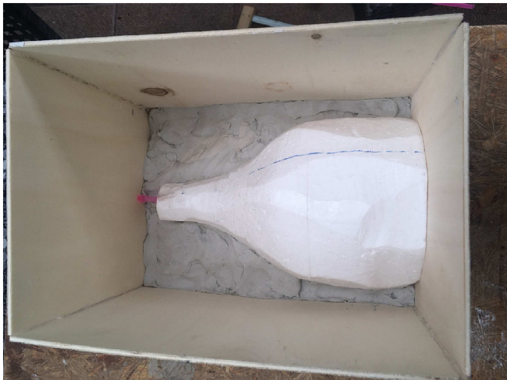
Obrázek 5.3. Polystyrenová předloha připravená na zalití sádrou
