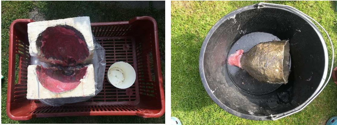
Obrázek 8.9. Vyjmutí stínidla z formy
