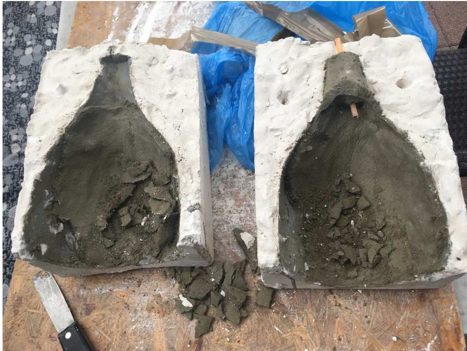
Obrázek 7.1. Sádrová forma s nedostatečnou povrchovou úpravou
