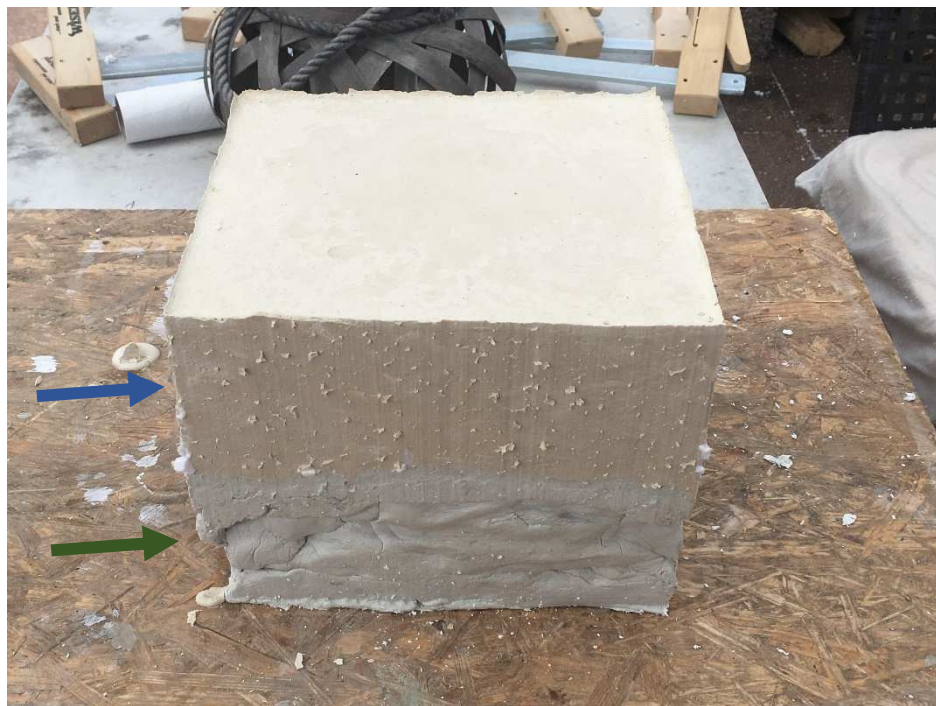
Obrázek 5.4. Hotová polovina sádrové formy vyjmutá z bednění
