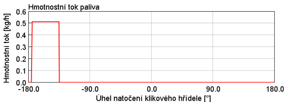
Obr. 41: Časový průběh hmotnostního toku paliva vstřikovačem do aktivní komůrky
