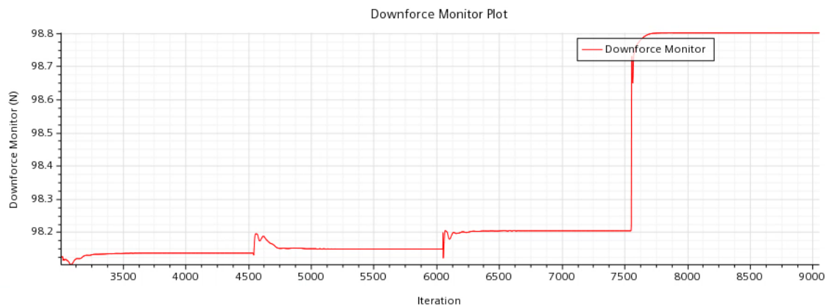
Obr. 51: Přítlak nejnovější více zdeformované verze
