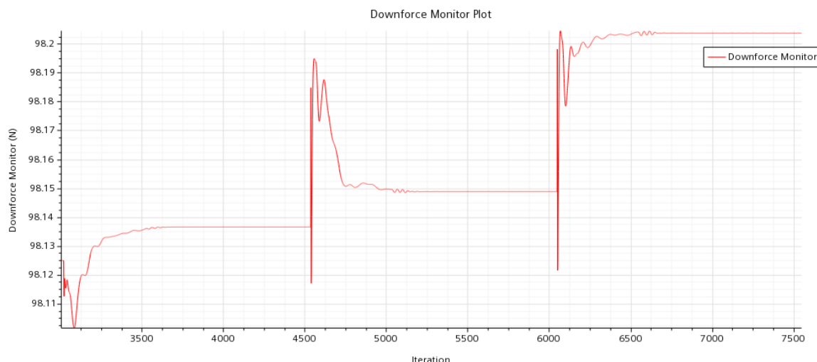
Obr. 49: Vývoj přítlaku předního křídla přes cykly adjoint solveru
