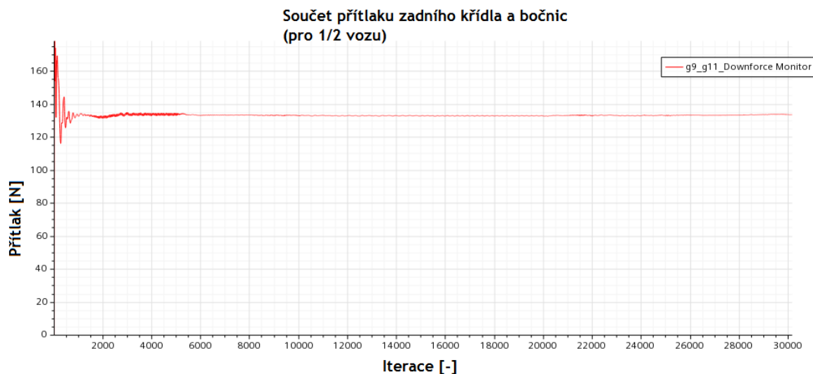
Obr. 40: Graf sledovaného přítlaku pro simulaci se zdeformovanou boční deskou s použitím prvního cyklu adjoint solveru po 20 000 iteracích
