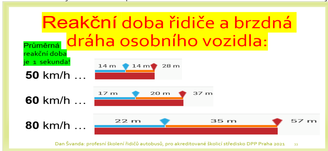
Obrázek 10: Reakční doba a brzdná dráha vozidla Zdroj: [17]
