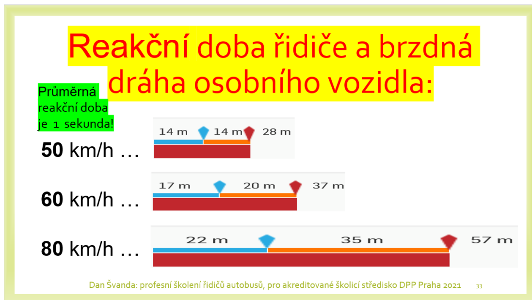
Obrázek 10: Reakční doba a brzdná dráha vozidla Zdroj: [17]
