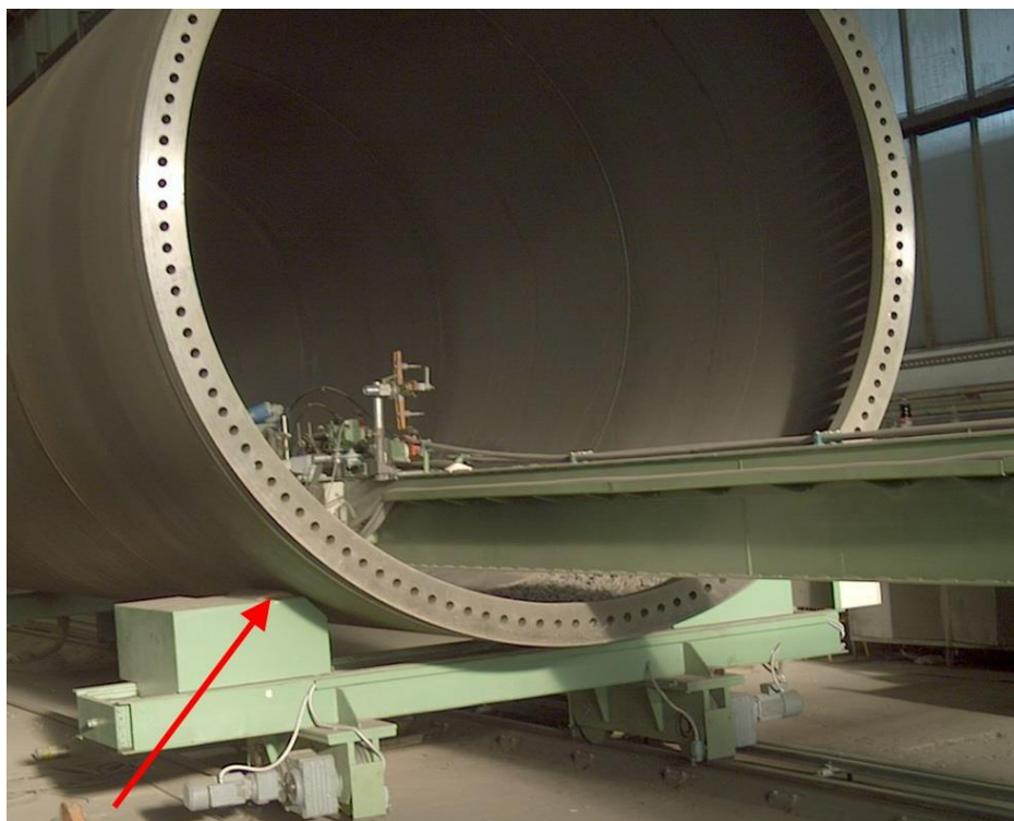
Obrázek 4- Ukázka přivařeného prstence na skruž pro šroubové spojení dvou dílů [1]
