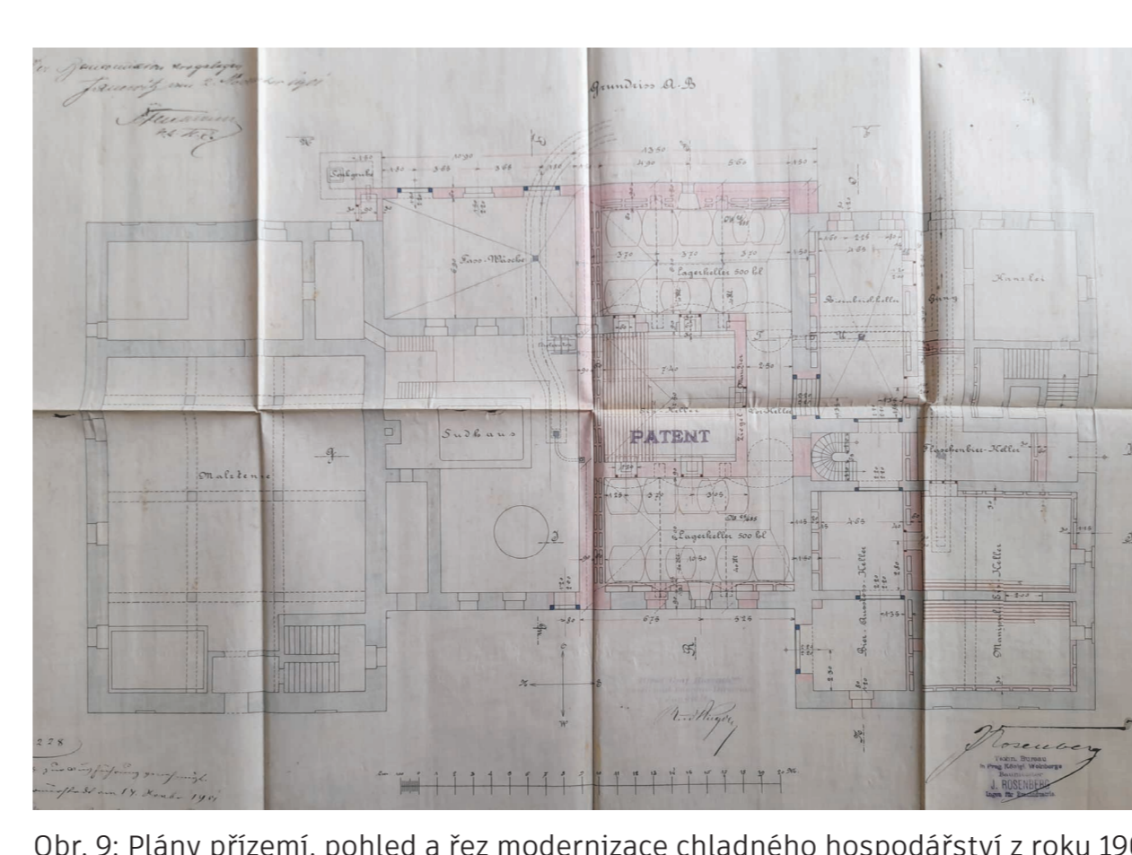
Obr. 9: Plány přízemí, pohled a řez modernizace chladného hospodářství z roku 1901 od stavitele J. Rosenberga pro Alfréda Karla Harracha, které barevně odlišují stávající a nové zdivo
