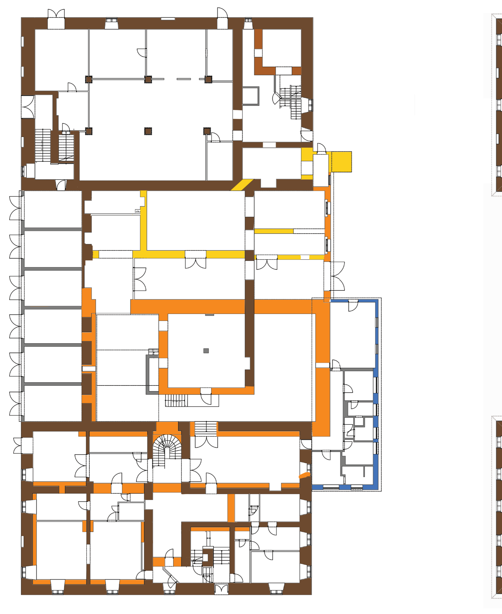
Obr. 12: Plán 2. patra a krovu pivovaru. Krov severní budovy sladovny (nahore) je pozdně barokní hambálkový. Krov nad varnou a jižní budovou byl vyměněn na poč. 20. století
