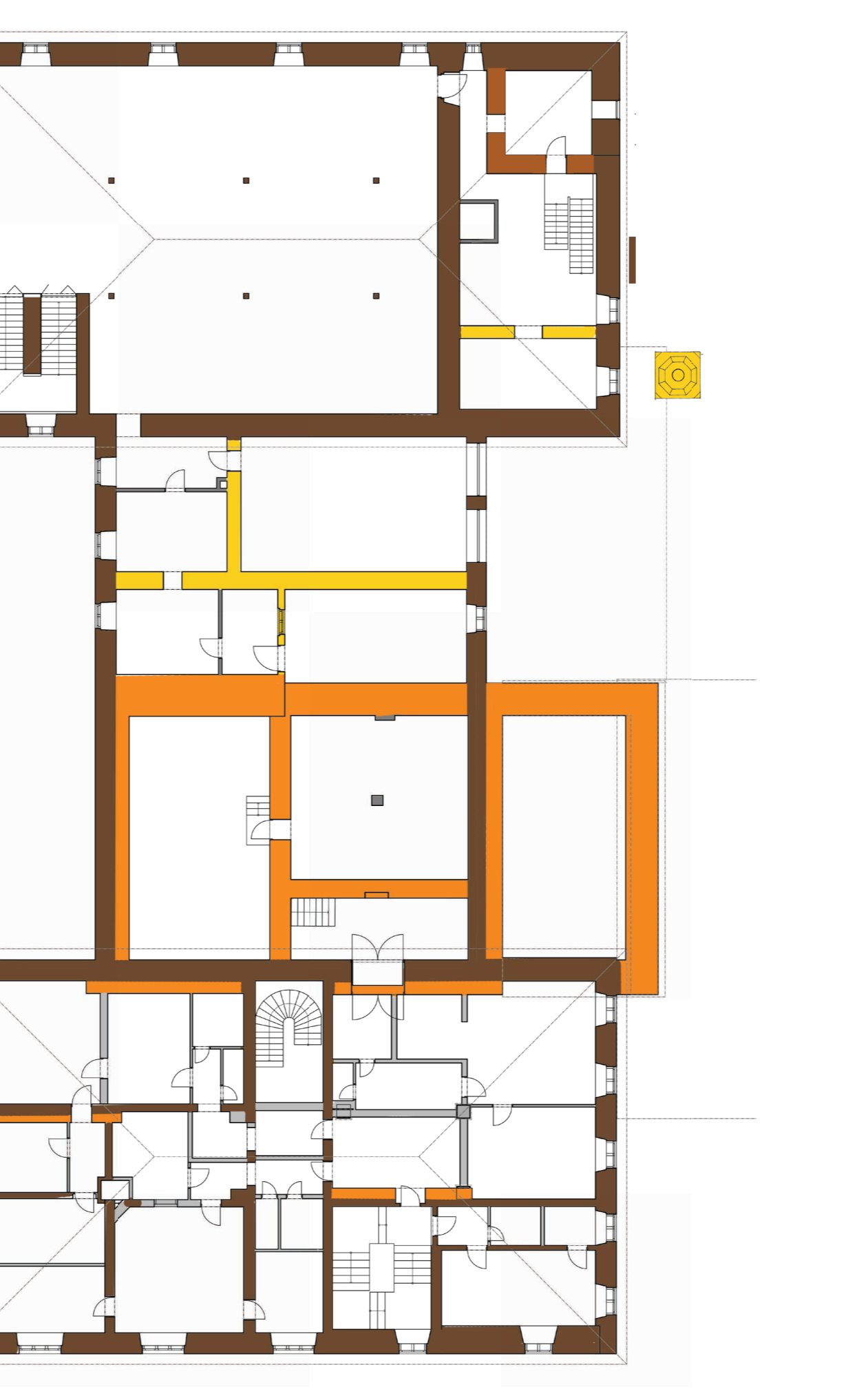
Obr. 10: Plán přízemí pivovaru s vyznačením stavebních fází. Nejstarší (hnědá) tvář číhly je podle plánů z roku 1901-1907 modernizován (rozříčkována a žitá). Humno je z konce 20. století rozříčkováno na kóje
