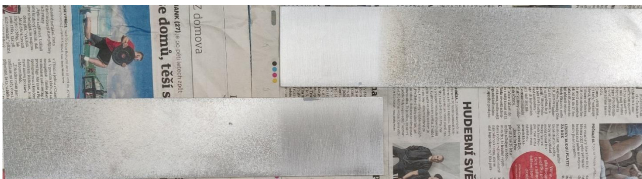
Obr. 27 – Adherendy po broušení
