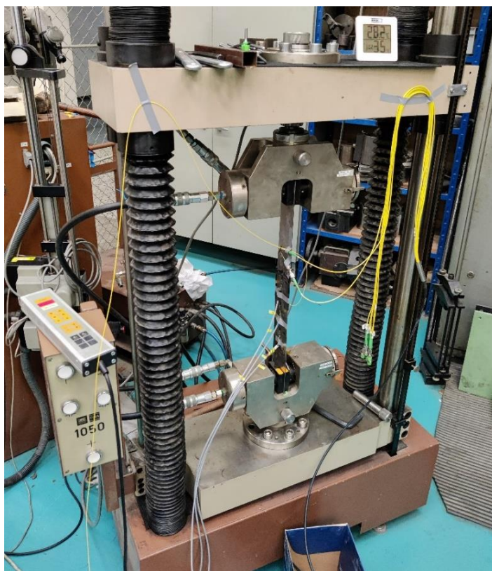
Obr. 33 – Zkušební vzorek s lepeným spojem umístěný v testovacím stroji
