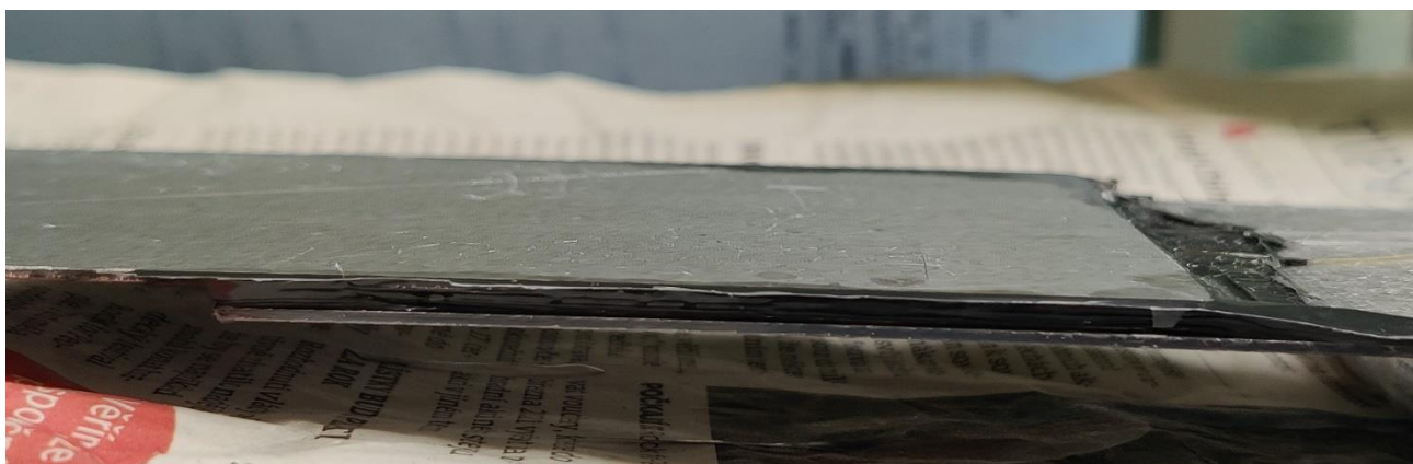
Obr. 30 – Detail lepeného spoje po vytvrzení
