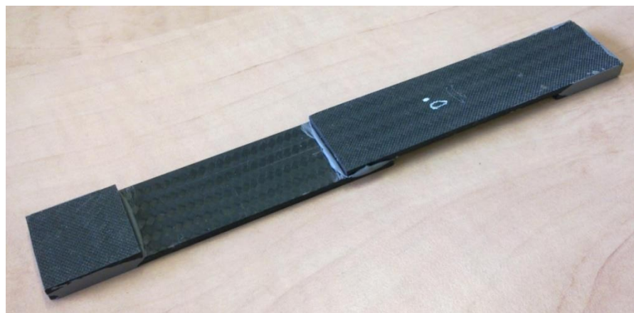
Obr. 17 – Vybraný lepený spoj, jenž byl analyzován během zkoušek
