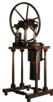
Obrázek 4 Stirlingův motor dle patentu z roku 1827 věnovaný Univerzitě v Glasgow v roce 1828
