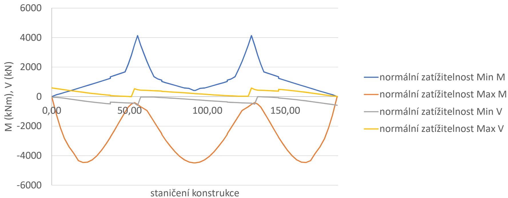
Obálka M,V normální zatížitelnosti od náprav 3NV vynásobená součinitelem roznosu a dynamickým součinitelem
