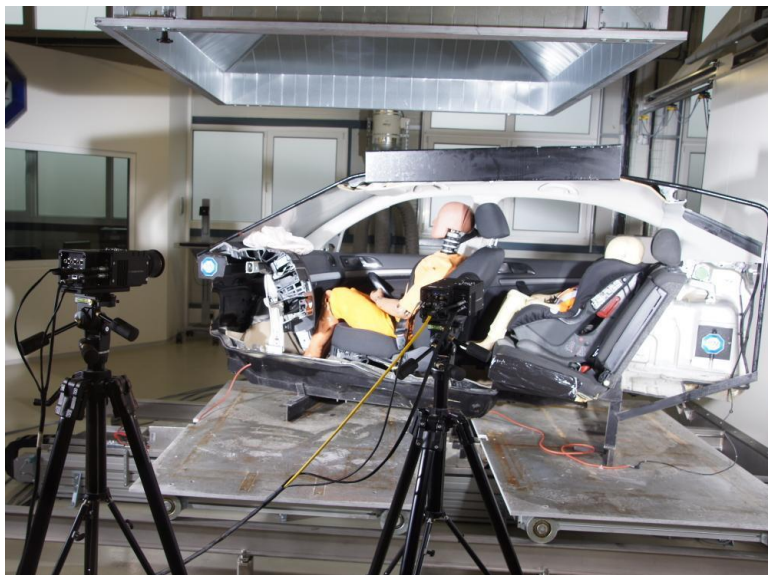
Obrázek 5.1: Snímek po zkoušce, kde je vidět část kostry vozu s interiérem osazeným airbagovým modulem. Dále jsou v popředí vidět vysokorychlostní kamery ručně nastavené do pozic pomocí stativů[31].
