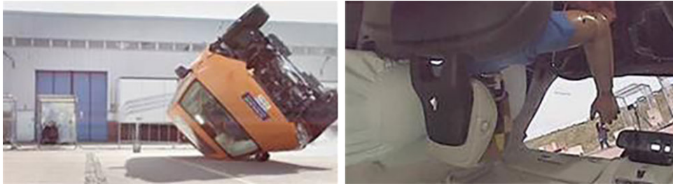
Obrázek 2.7: Test hlavového a bočního airbagu při převrácení vozidla. Z fotografií je vidět, že airbagové vaky zůstávají nafouknuté. Vaky zůstávají nafouklé řádově desítky sekund. [11]
