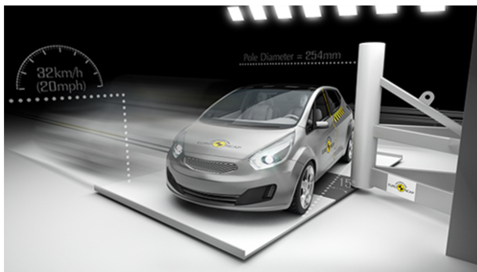
Obrázek 4.4: Grafické znázornění bočního nárazu do úzké tuhé bariéry v rámci nárazových zkoušek Euro NCAP [29].
