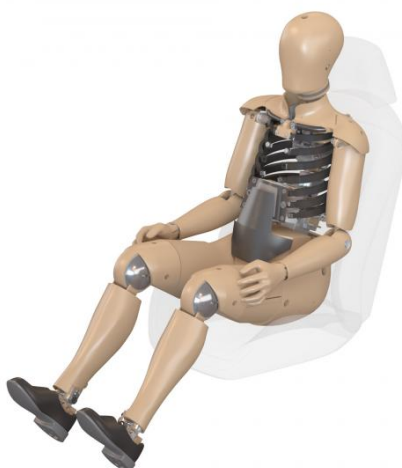
Obrázek 4.1: Figurína THOR-50 M používaná při testech čelního nárazu, umožňující přesné stanovení biomechanických rizik poranění. [28]
