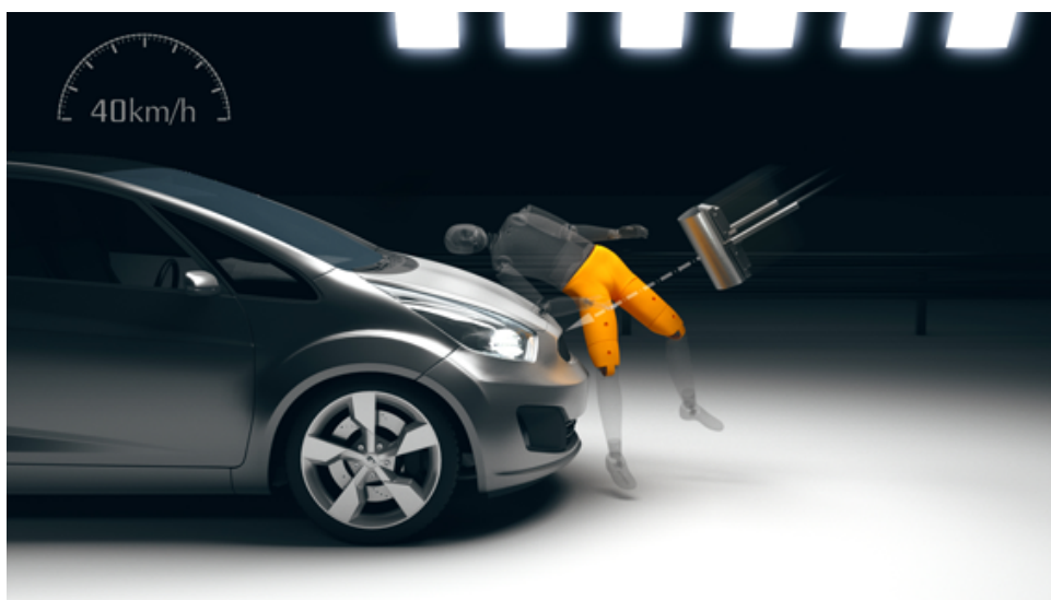
Obrázek 4.7: Grafické znázornění srážky vozidla s chodcem v rámci nárazových zkoušek Euro NCAP testující horní část nohou[29].
