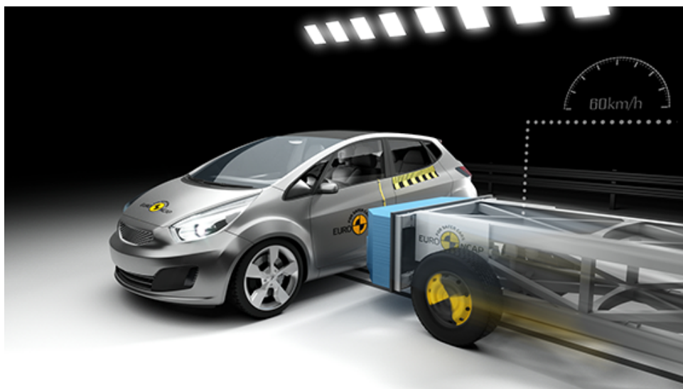
Obrázek 4.5: Grafické znázornění bočního nárazu deformovatelné bariéry do vozu v rámci nárazových zkoušek Euro NCAP [29]
