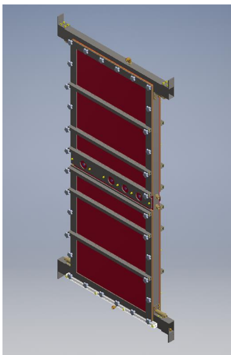
Obr. 3.1-1: 3D model deskového fotobioreaktoru
