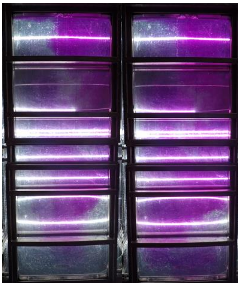
Obr. 3.4-6: Tvorba cirkulačních smyček v komoře
