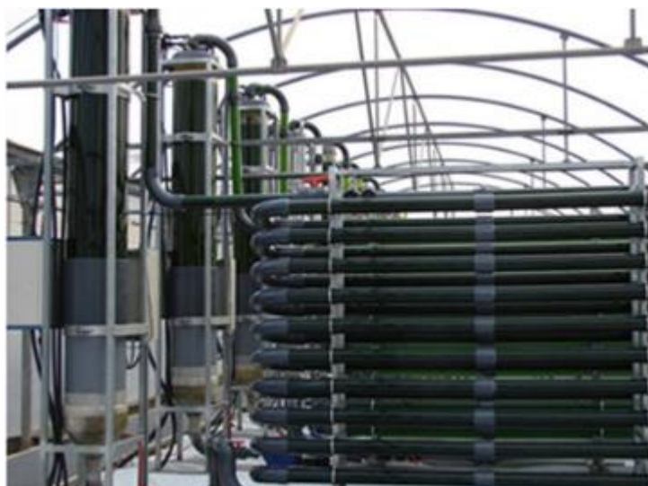
Obr. 2.4-2: Vertikální varianta trubkového FBR [3]
