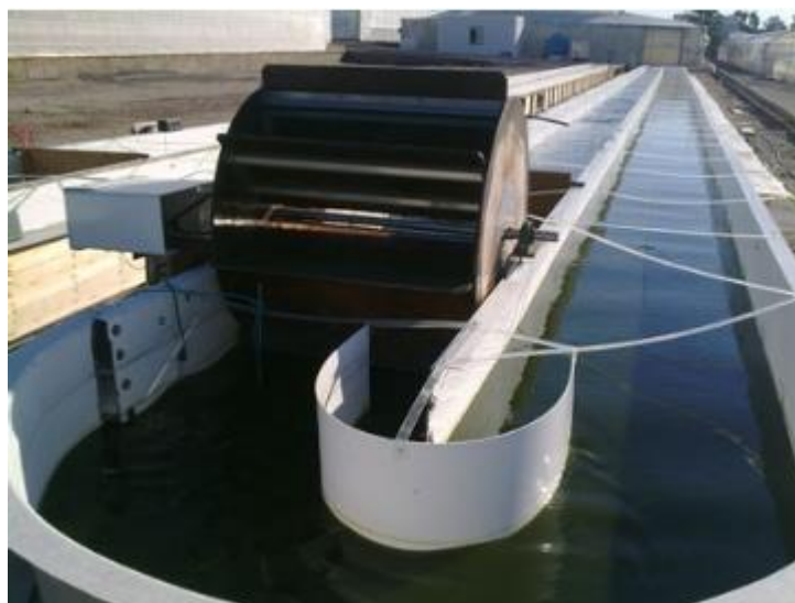
Obr. 2.3-1: Traťový systém s lopatkovým kolem [3]
