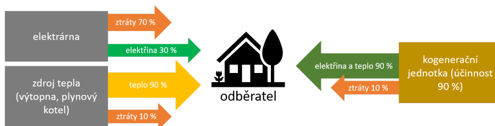
Obrázek 1.1: Princip kogenerace 4
