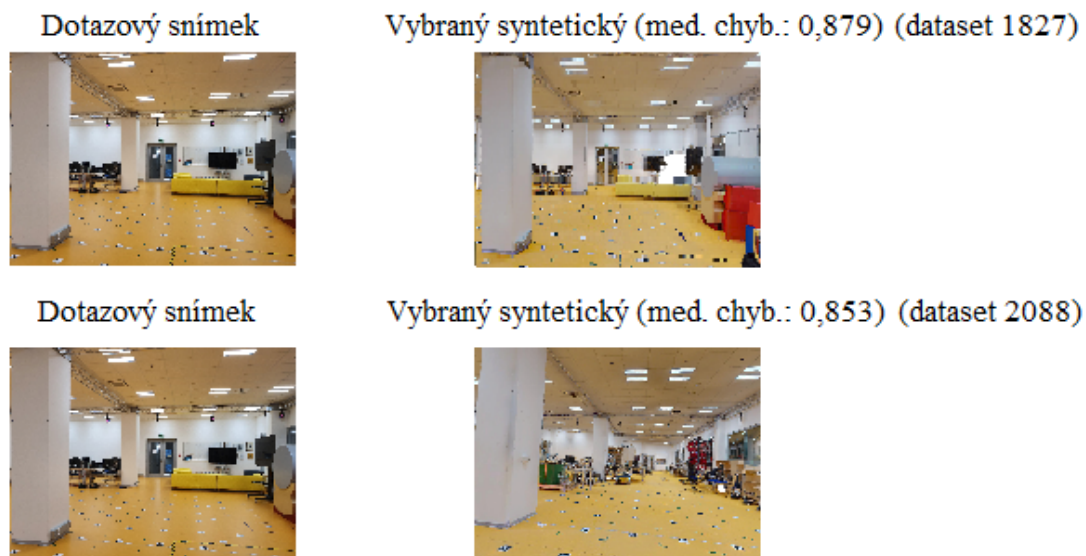
Obrázek 5.17: Stejný dotazový snímek, ale zcela odlišné syntetické snímky ze dvou různých míst. Pro dataset o velikosti 1827 se lokalizace zdařila, pro dataset o velikosti 2088 selhala. Vybraný syntetický snímek dosáhl nižšího mediánu chyb deskriptoru DSIFT, a proto byl vybrán.
