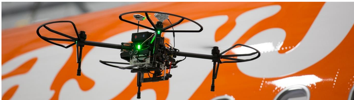
Obrázek 5: Dron Rapid při inspekci dopravního letadla aerolinky EasyJet v hangáru [51]
