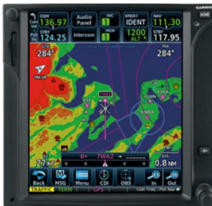
Obrázek 10 – Zobrazení systému HTAWS v kabině vrtulníku [42]
