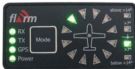
Obrázek 7 – Ukázka zobrazení FLARM na palubě letadla (provoz aktuálně na 11 hodině pod polohou letadla) [34]
