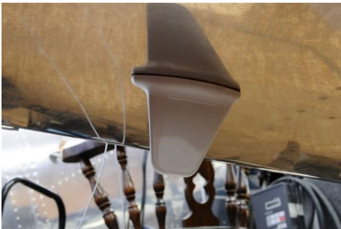
Obr. 4 Umiestnenie antény odpovedača Garmin GTX 327 na spodnej strane trupu
