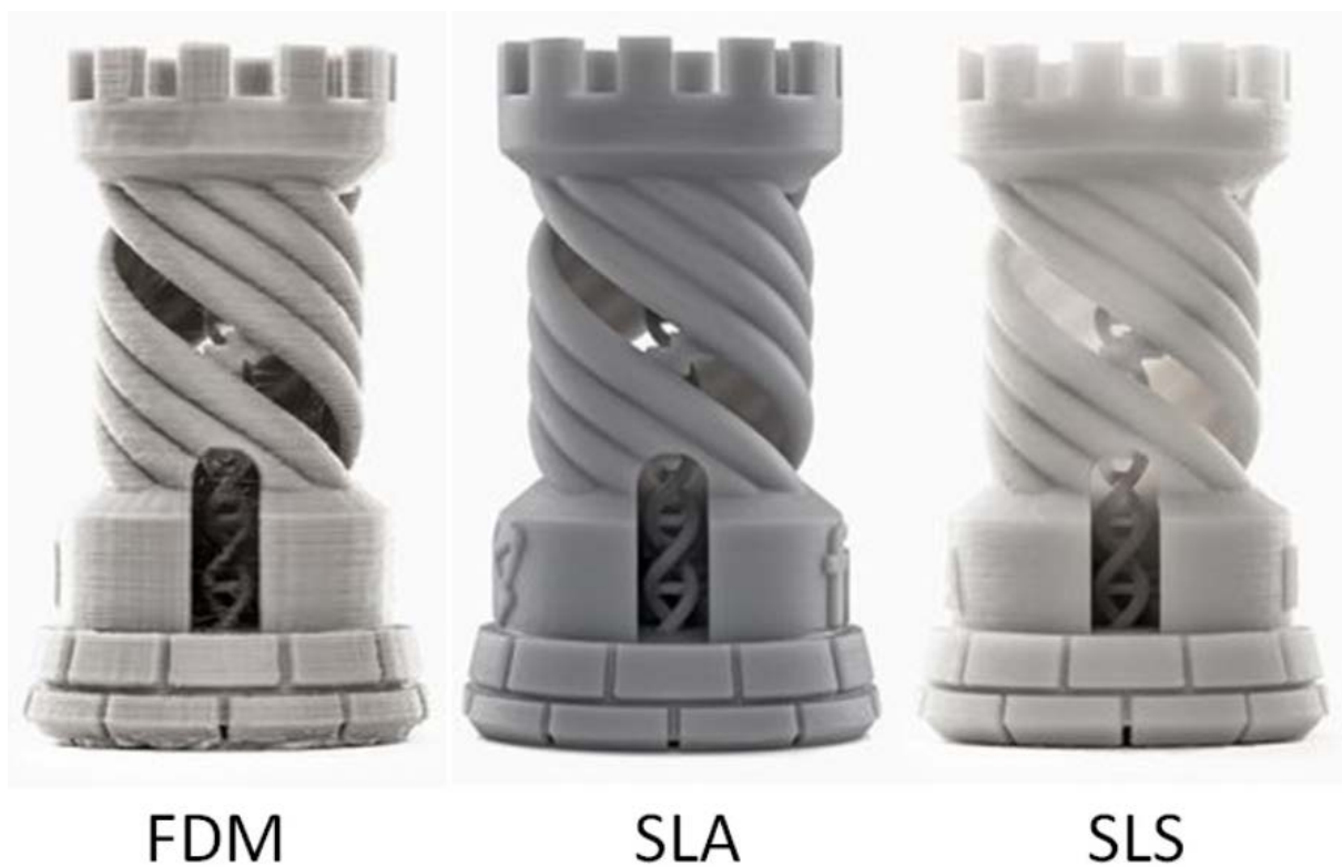
Obrázek 4 - Porovnání jednotlivých technologií 3D tisku [29]
