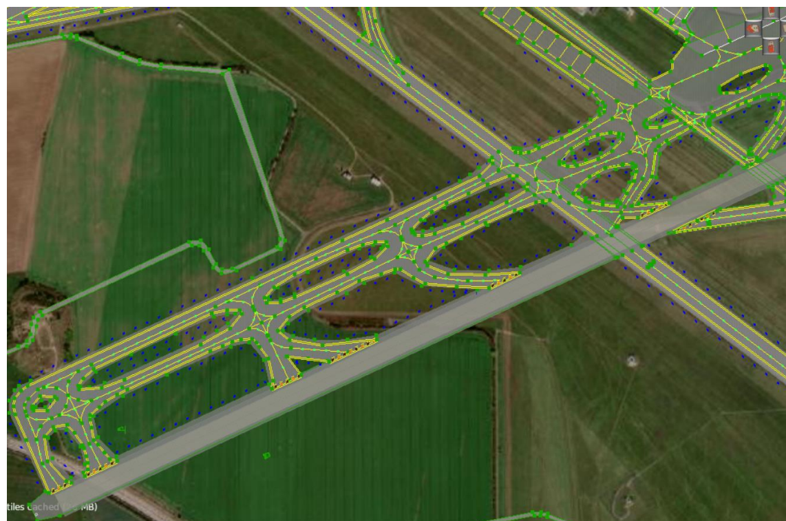
Obrázok č.9- Sieť podvozového svetelného značenia [autor]
