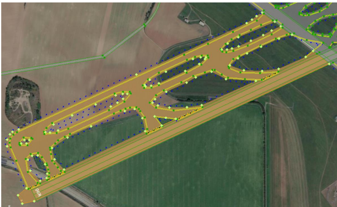
Obrázok č.6- Základová štrkovo-cementová vrstva pojazdových dráh [autor]
