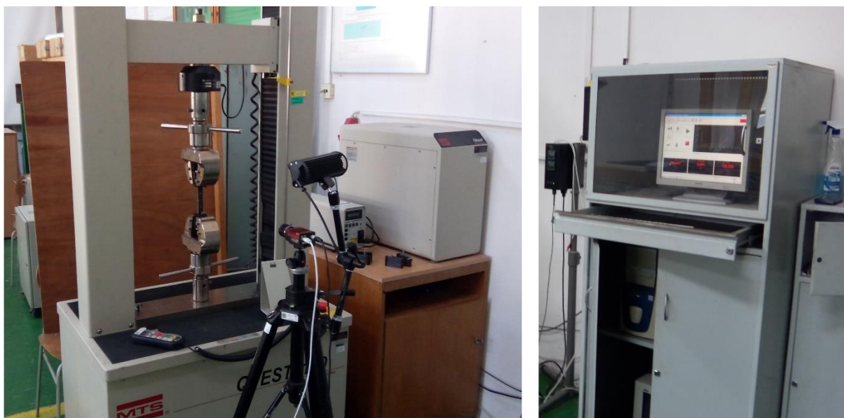
Obr. 4.18: Uspořádání zkušebního zařízení pro materiálové zkoušky component systému ERS Corkelast (vlevo: zkušební zařízení MTS QTEST 100 a optický extenzometr SOBRIET; vpravo: řídicí PC stanice systému MTS QTEST 100)
