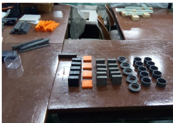
Obr. 4.14: Tělíska pro zkoušení v tlaku (zleva: Corkelast Va-60, Traceklast strip, PUR Fillerblock, PVC tube).
