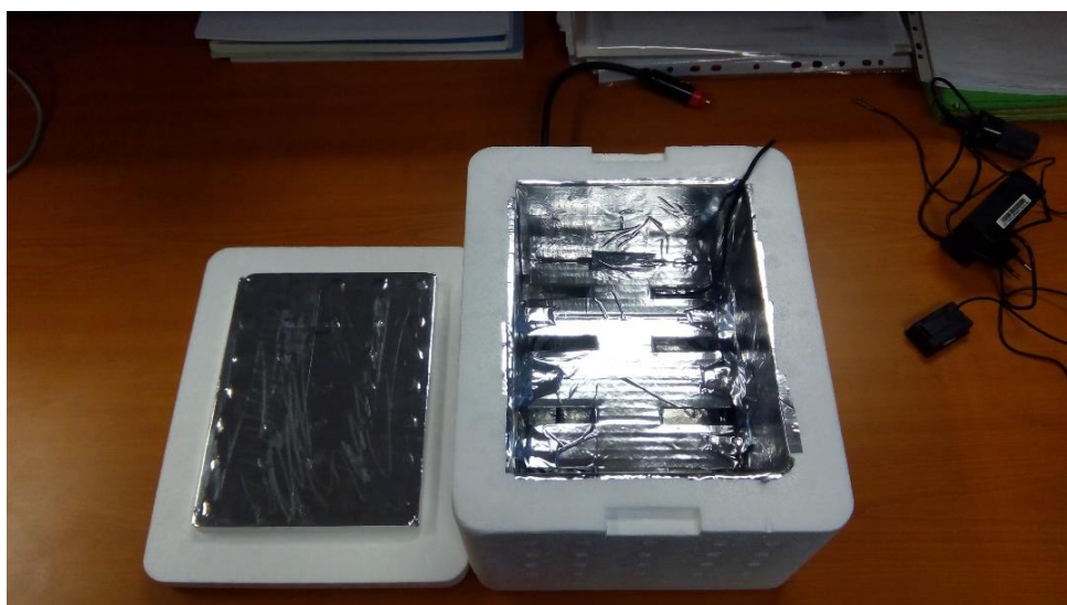
Obr. 4.17: Úprava vnitřního prostoru izotermického boxu včetně roštu pro umístění zkušebních těles.
