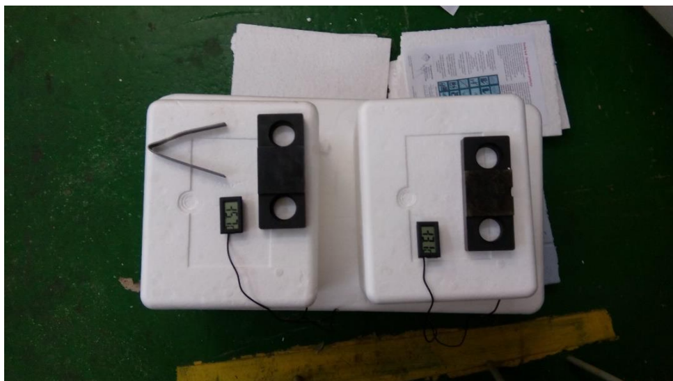
Obr. 4.16: Temperování zkušebních těles v izotermických boxech.
