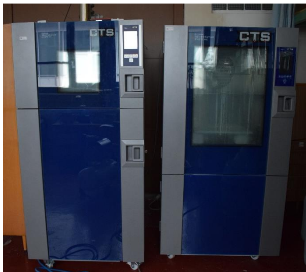
Obrázek 71. Klimatické komory použité pro experiment na kinetiku intermetalických sloučenin. Zleva šoková komora a teplotně-vlhkostní komora
