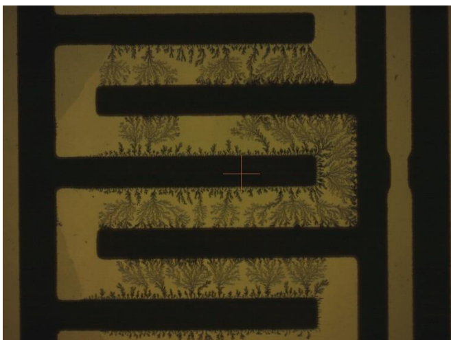
Obrázek 25. Elektrochemická migrace na standardním testovacím motivu (migrace mědi)
