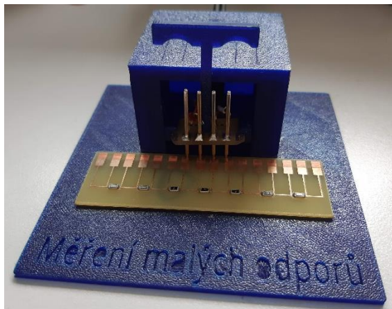
Obrázek 14. Přípravek pro měření malých odporů
