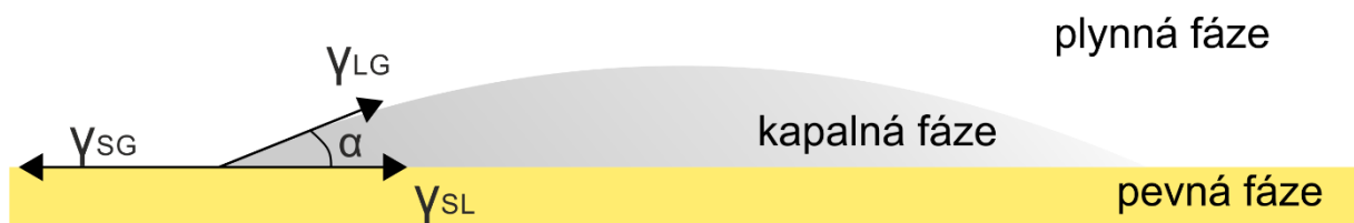
Obrázek 2. Rovnovážný stav povrchových napětí
