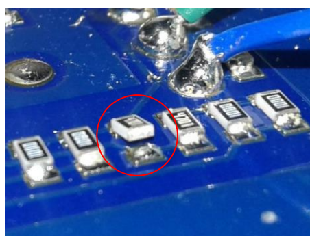
Obrázek 19. Ukázka efektu náhrobního kamene u reálného výrobku (vlastní dokumentace)
