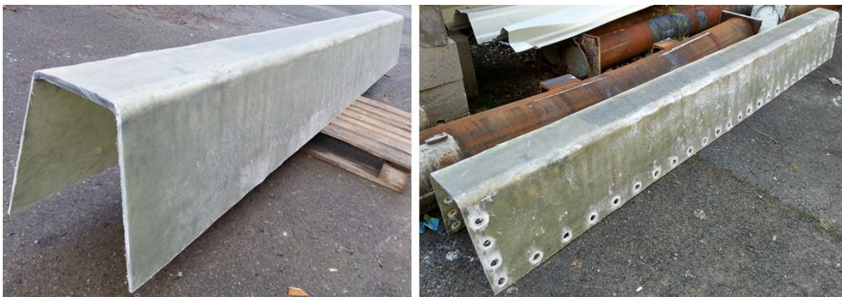
Obr. 59 Výroba FRP nosníku – ořezání hran, vyvrtání otvorů
