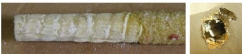
Obr. 8 Detail soudržné části výztuže po vytržení z betonu
