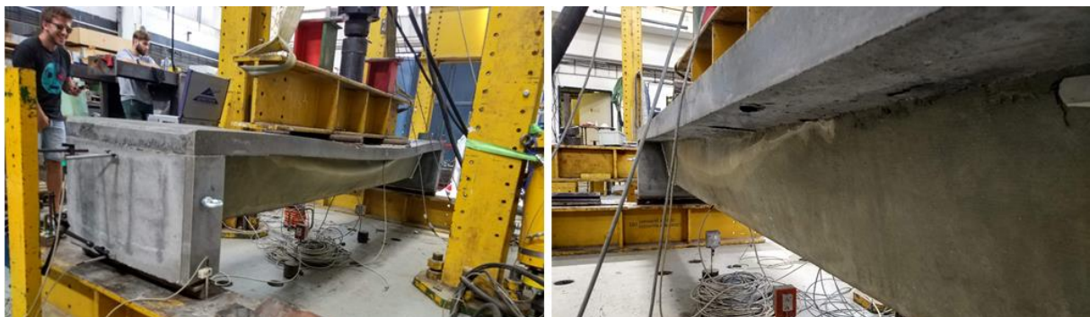
Obr. 72 Nosník po kolapsu, vyboulení stojiny nosníku
