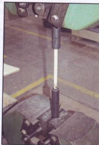
Uspořádání zkoušky modul pružnosti v tahu a zkoušky pevnosti v tahu
