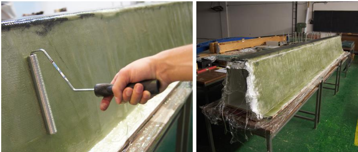
Obr. 58 Výroba FRP nosníku – eliminace vzduchových bublin pomocí válečku, vytvrzování pryskyřice
