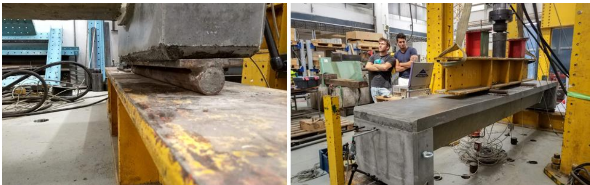
Obr. 71 Způsob podepření nosníků, připravený nosník připravený k zatěžování
