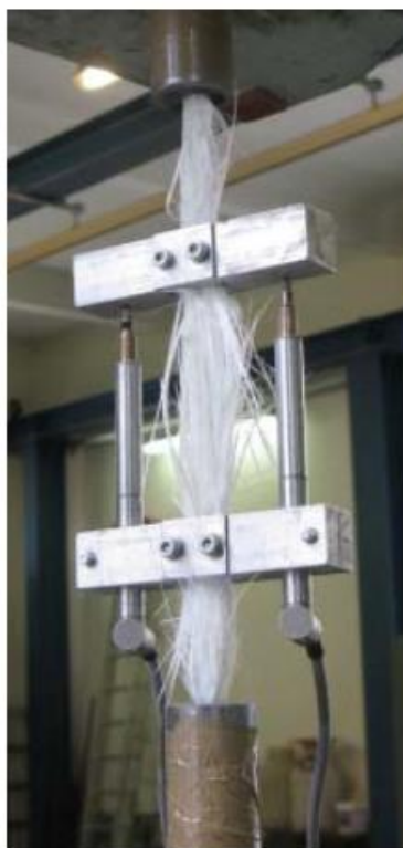
Obr. 6 Porušení vzorku při tahové zkoušce
