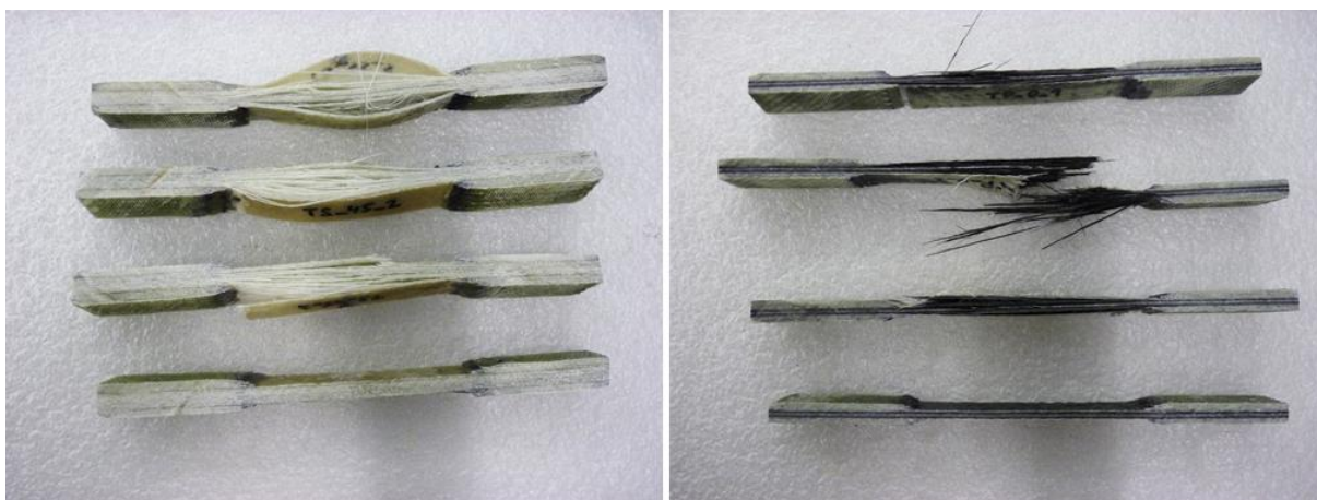
Obr. 66 Zkušební vzorky stojiny vlevo, zkušební vzorky uhlíkové pásnice vpravo
