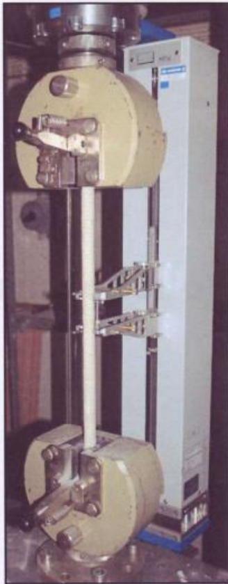
Uspořádání zkoušky modul pružnosti v tahu a zkoušky pevnosti v tahu
