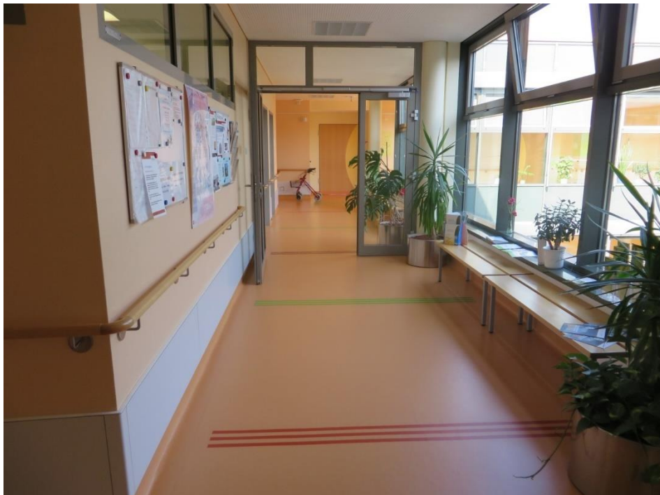
Obrázek 14: Pruhy na podlaze v interiéru jsou umístěny v místech, kde se předpokládá častější freezing u pacientů, typicky v místech ostré změny směru chůze a v místě průchodů dveřmi (Alexianer Klinik Bosse, Wittenberg).
