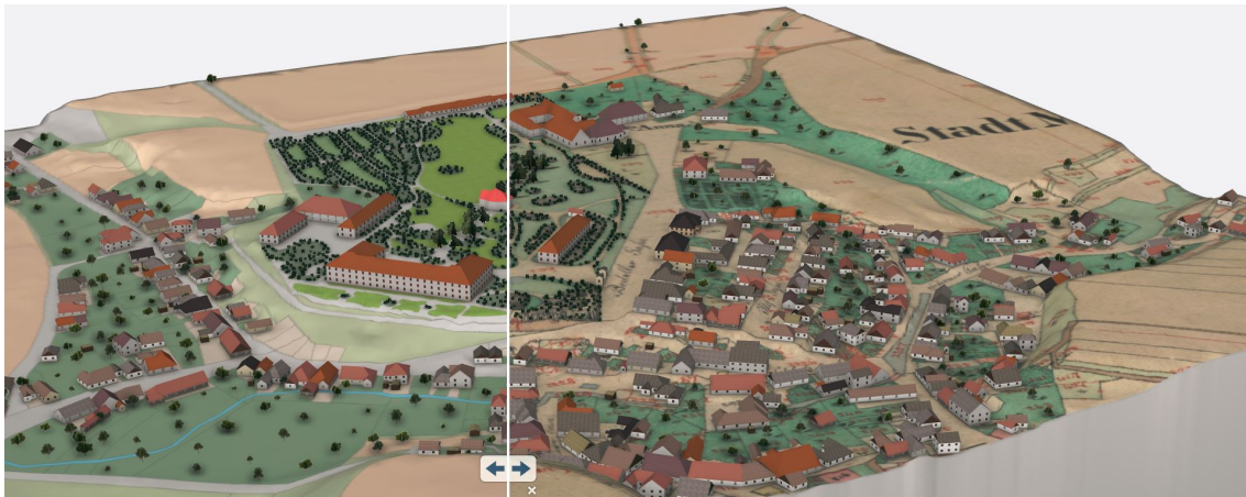
Obr. 5.3: 3D scéna s texturou na DMT – vpravo rastrový obraz staré mapy a vlevo její vektorová podoba
