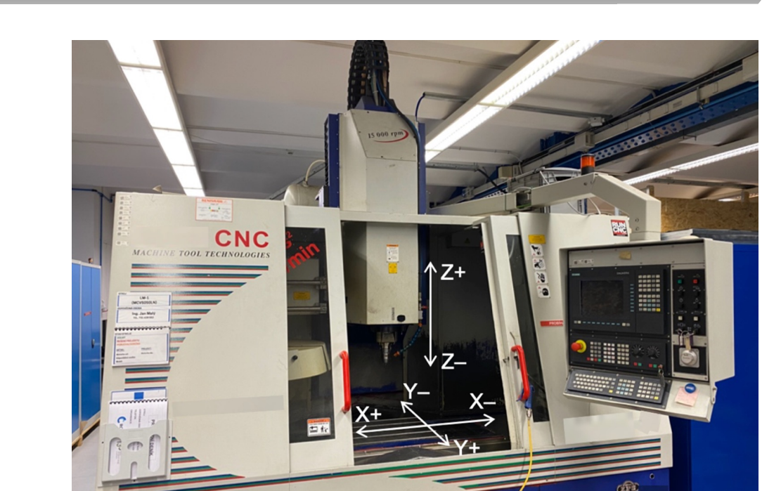
Obr. 9: Středně velké obráběcí centrum
