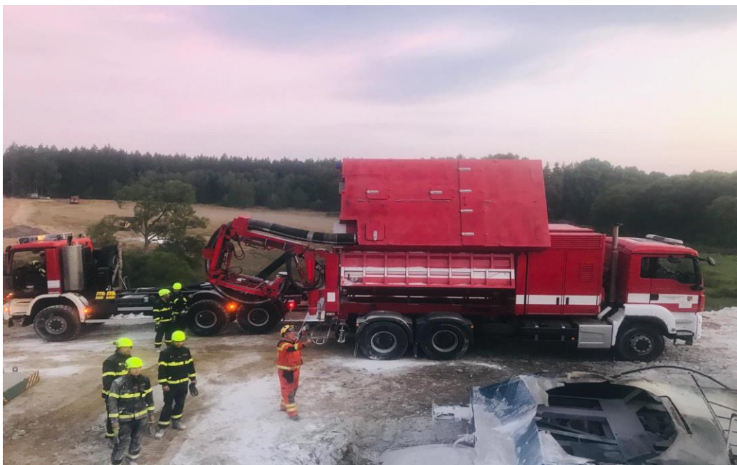
Obrázek 7 - Sací bagr (zdroj Záchranný útvar)
