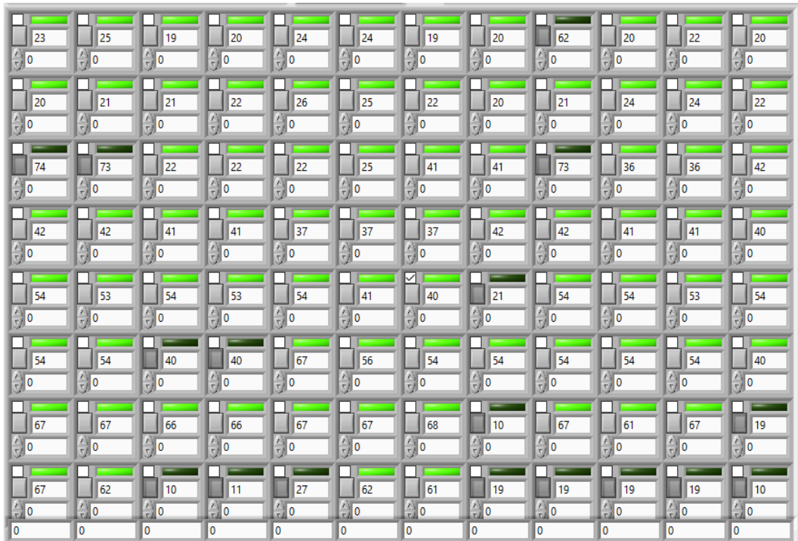
Obrázek 4.8: Příklad odpojení vadných hodnot. Zhaslé ledky ukazují odpojené signály (autor)
