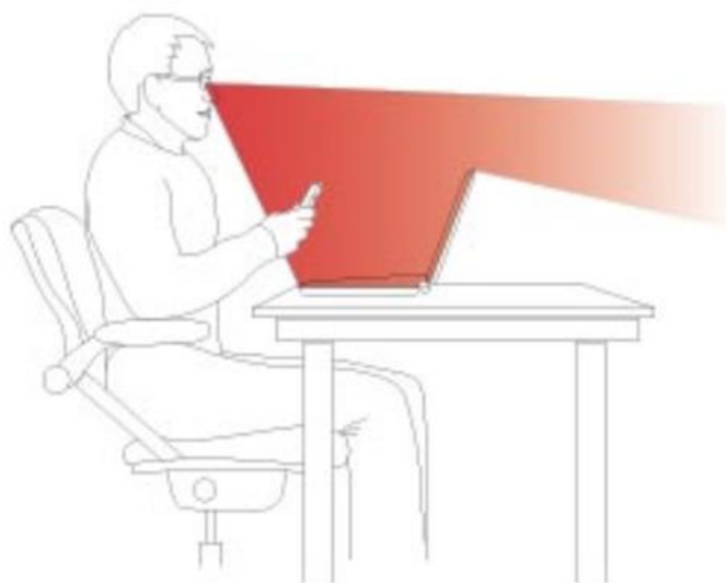
Obrázek 10: Rozsah pracovní vzdálenosti s degressivními brýlovými čočkami [30]
