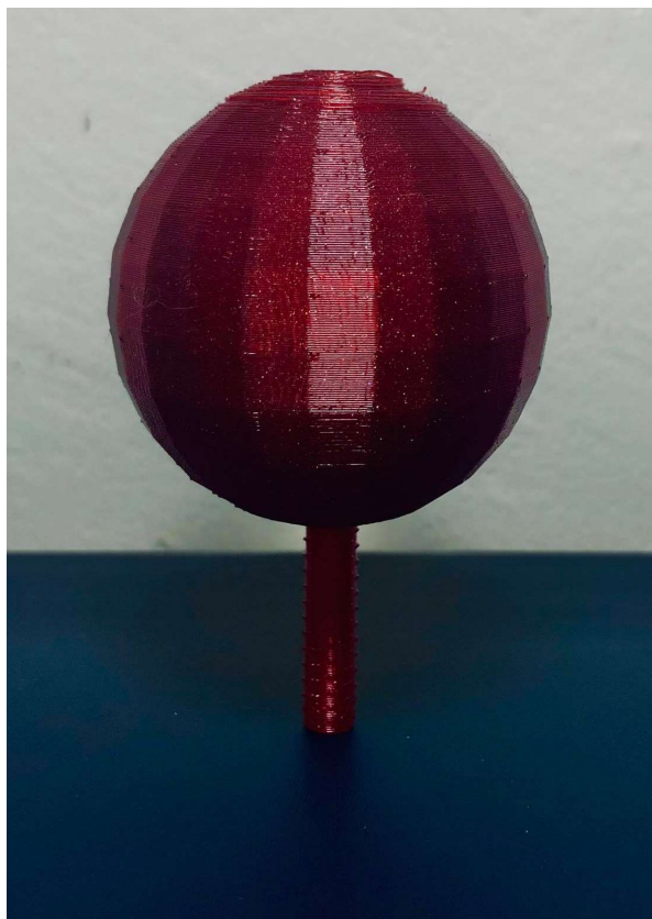
Obrázek 9.7. Forma pro tekutý fantom nádoru převzato z [26].
