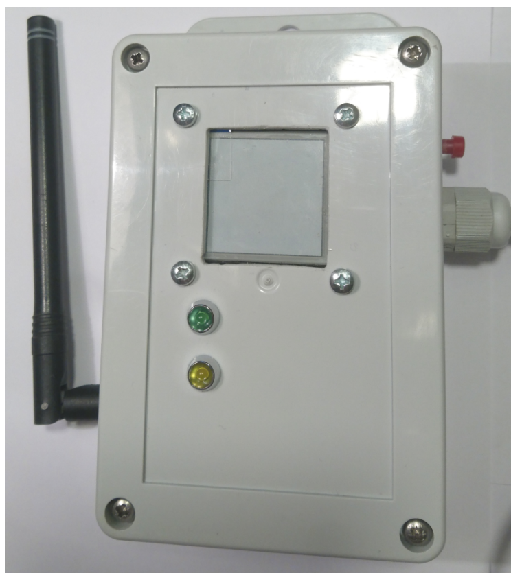
Obrázek 3.5: Přijímač s připojenou anténou a vyvedeným USB kabelem pro připojení k PC
