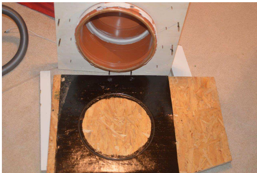
obr. 32: Osazení komory na vzorek přes těsnící vrstvu z asfaltového pásu
