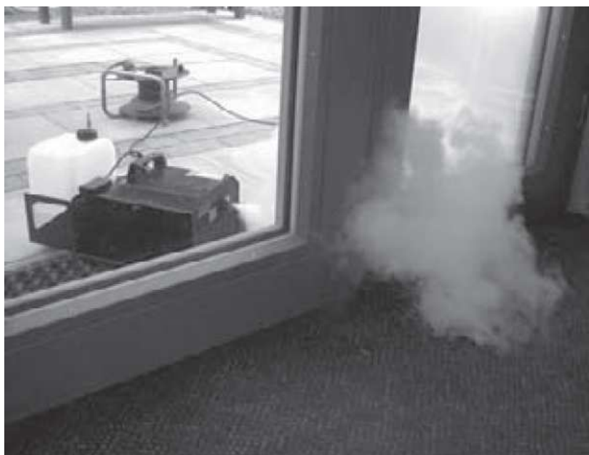
obr. 6: Detekce netěsností pomocí kouřostroje [2]
