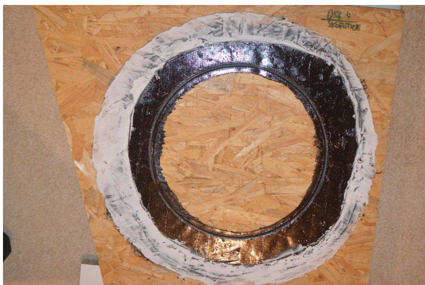
obr. 44: Vzorek desky ve stavu po nanesení akrylátového tmelu v rozsahu 10 cm od hrdla
