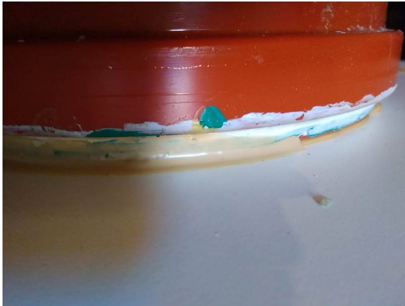
obr. 34: Osazení komory dotěsněním na vzorek lepicím tmelem
