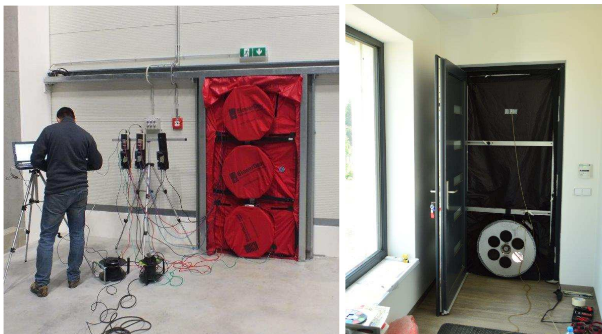
obr. 4: Osazení Blower door testu na objektu logistické haly vlevo a na objektu rodinného domu vpravo (archiv autora)
