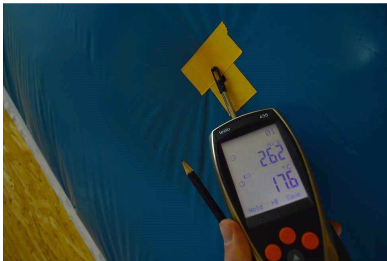
obr. 16: Měření rychlosti proudění vzduchu na výtokovém otvoru z plastové fólie přilepené na vzduchotěsnicí OSB desce objektu při vyvolaném podtlaku v interiéru, měřená hodnota 2,62 m/s (archiv autora)
