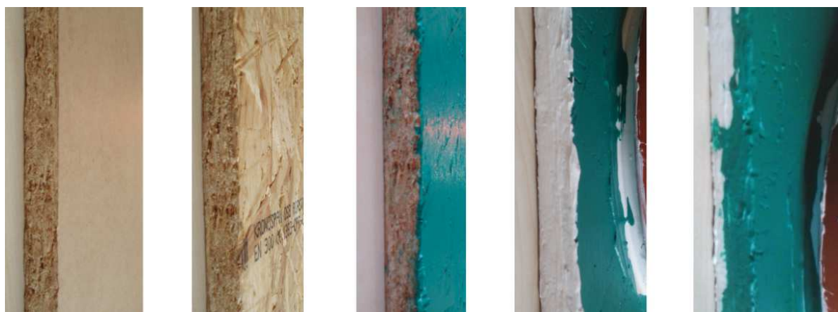
obr. 21: Úpravy měřeného vzorku OSB desky s povrchovou úpravou z nakaširovaného kartonu (zleva a) ze strany nakaširovaného papíru, b) ze strany bez povrchové úpravy, c) ze strany bez papíru + akrylátový nátěr z přilehlé strany desky okolo přisazené komory, d) DTTO + zatření hrany desky akrylátovým tmelem, e) DTTO + druhá vrstva akrylátového nátěru z přilehlé strany okolo přisazené komory
