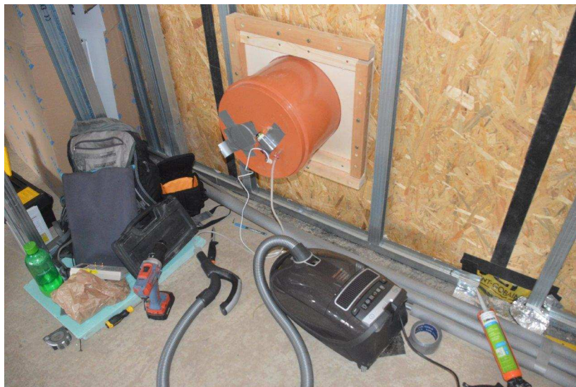
obr. 63: Testovací sada s komorou upnutou na vzorek
