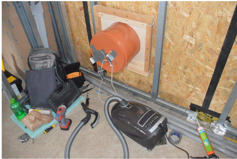
obr. 9 Experimentální měření metodou tlakového impulsu (archiv autora)
