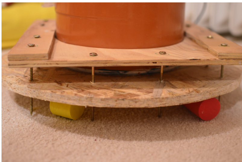
obr. 37: Dotlačení komory na vzorek pomocí vrutů do dřeva
