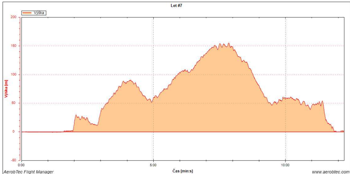
obr. 20: Záznam výšky letu modelu RC letadla, na svislé ose je uvedena jeho relativní výška. Pilot vypíná motor ve výšce 29,6 m (první peak), poté hledá termiku, zprvu marně. Klesá až do výšky cca 15 m. Po minutě od startu nachází stoupavý proud vzduchu a získává výšku 90 m. Stoupák se rozpadá, hledá dál, v čase 5:00 nachází další stoupák, ve kterém dokrouží až do výšky přes 150 m. Následuje opět klesání v nepříliš dobrém vzduchu, ale ve výšce kolem 50 m nachází tzv. nulku (vzduch mírně stoupá, letoun se drží zhruba v konstantní výšce). Následuje sestup na přistání, aby pilot nepřekročil časové okno 10 minut, které má vymezené na let.
