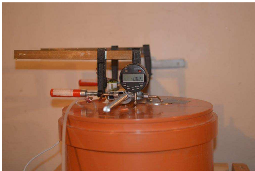
obr. 54: Měření deformace komory
