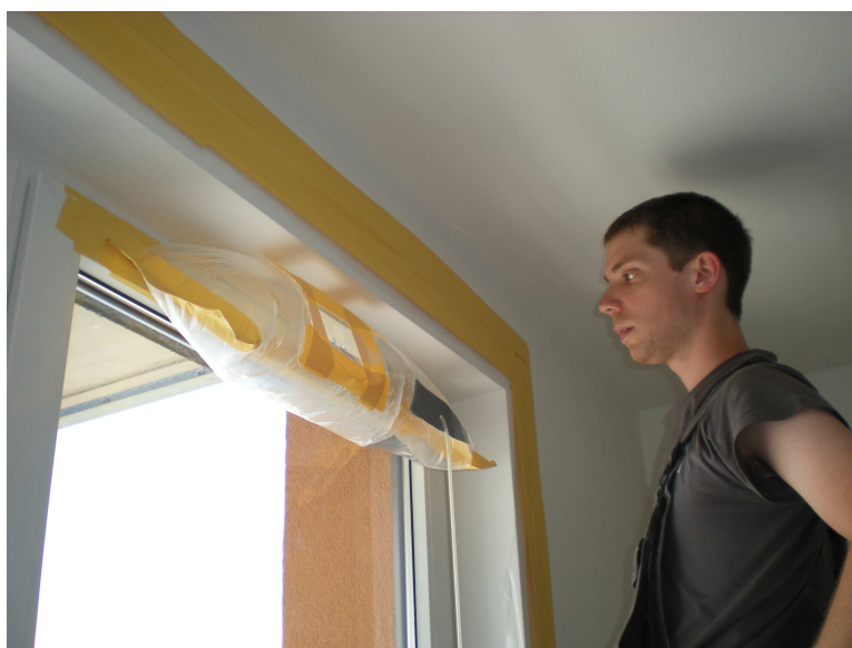
obr. 8: Měření průvzdušnosti okenní ventilační klapky (archiv autora)
