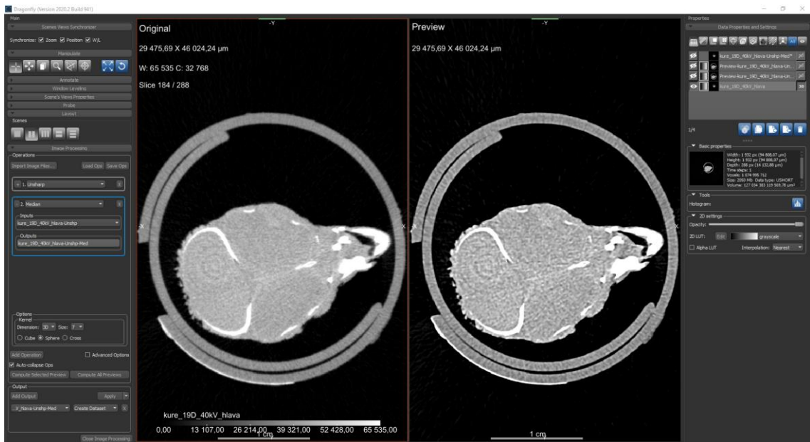
Obr. 4.19: Filtrace tomografických dat – vlevo: řez před úpravou; vpravo: řez po doostření a následném vyhlazení obrazu [zdroj: autor]
