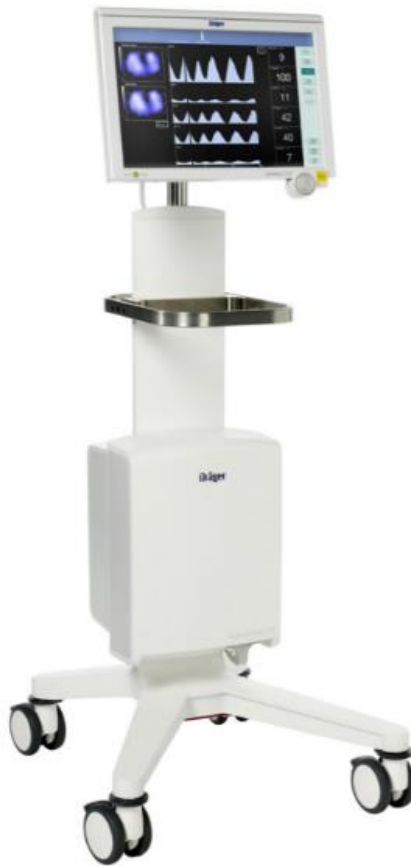
Obrázek 3.2: EIT Dräger PulmoVista 500 [34]
