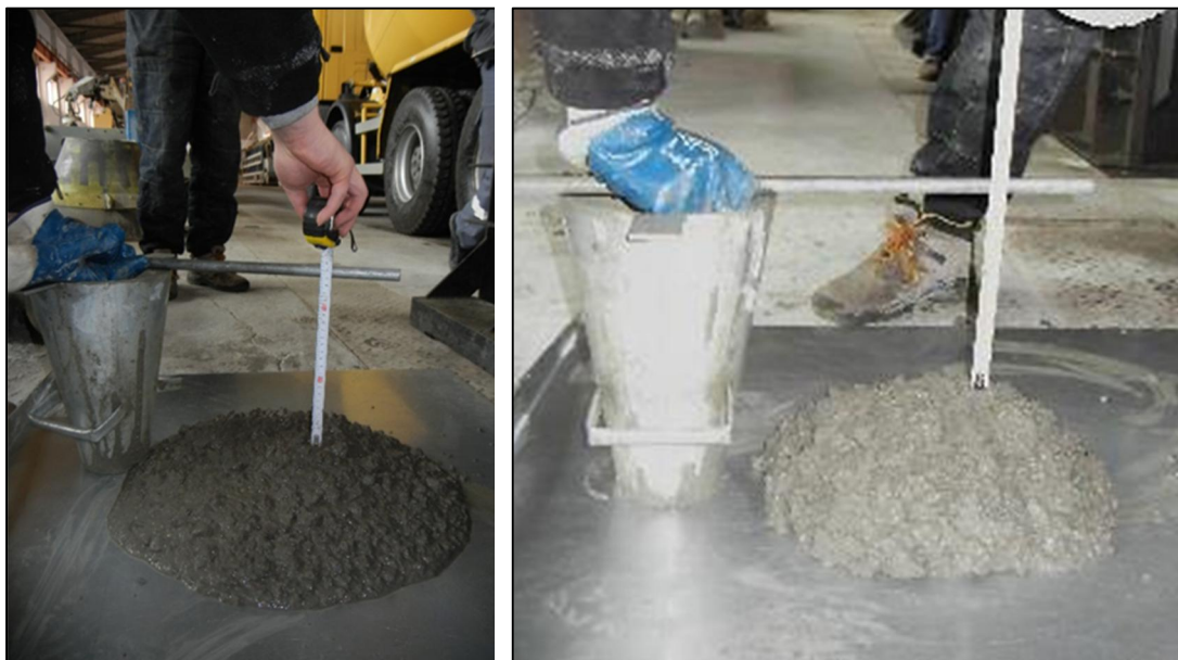
Obr. 28a a 28b 28a - Vzhled betonu podle receptury H31-2 (s přísadou HF 6) po zkoušce sednutím v čase 5-10 min. 28b - Vzhled betonu podle receptury H33 (s přísadou HF 13) po zkoušce sednutím v čase 5 – 10 min.
