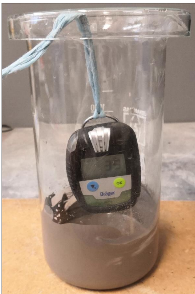
Obr. 41 Měření amoniaku ve vzduchu těsně nad míchanou směsí pomocí analyzátoru DRÄGER PAC 8000 NH 3 .
