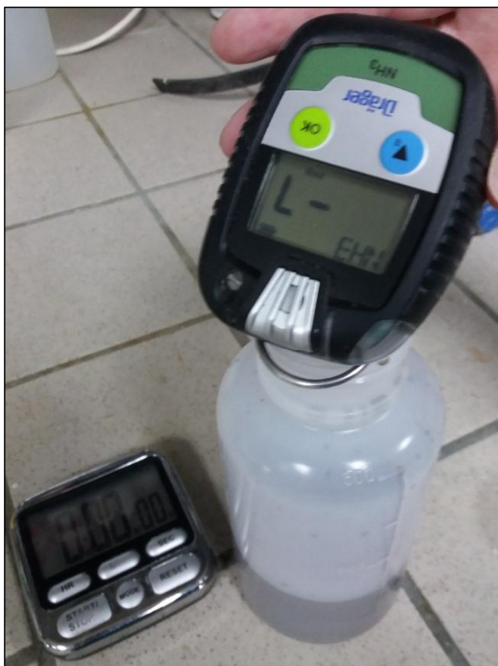
Obr. 44 Snímač přístroje DRAGER PAC 8000 NH3 - přístroj před zahájením měření - umístěn uprostřed hrdla zkušební lahvičky, musí být čidlem dolů, zde ilustrace displeje. Vlevo stopky pro měření 30 s.
