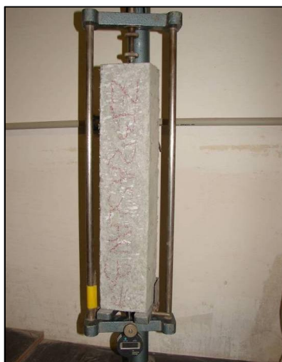
Obr. 31 Měřicí zařízení pro diskrétní měření délkových změn zkušebních trámců
