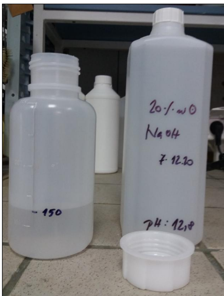
Obr. 42 Zkušební lahvička - vlevo, objem 500 ml, průměr 70 mm, výška 170 mm, průměr hrdla 35 mm, vpravo připravený 2 % roztok NaOH, pH 12,8.
