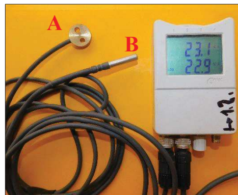
Obr. 34: Detail měřicího zařízení, s příložnou sondou (A) a teplotní sondou (B), typ S0141 [85]
