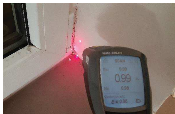
Obr. 39: Měření povrchové kritické teploty in situ, zobrazení aktuální povrchové teploty 11,9 °C
