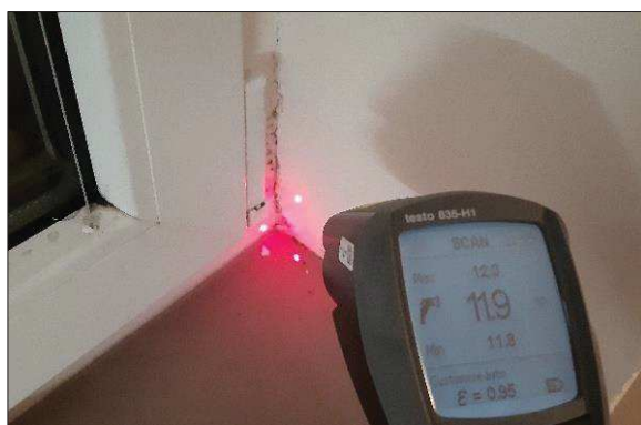
Obr. 39: Měření povrchové kritické teploty in situ, zobrazení aktuální povrchové teploty 11,9 °C
