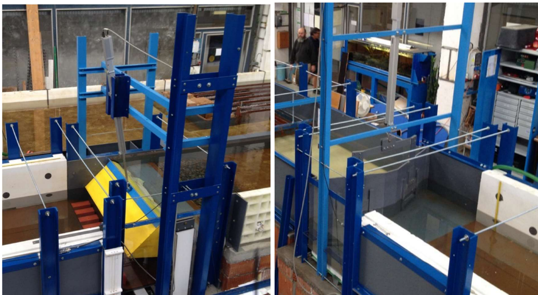
Obr. 4.6 Segmentová (vlevo) a vzpěrná (vpravo) vrata v horním ohlaví včetně lineárního motoru
