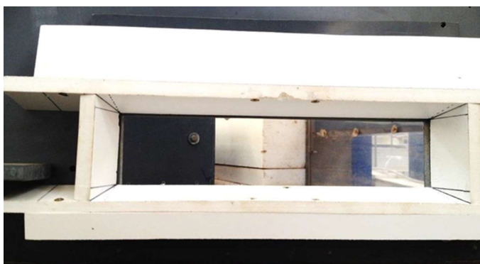
Obr. 4.25 Detail úpravy plnicích otvorů s horizontálním a vertikálním rozšířením na fyzikálním modelu – Varianta V6
