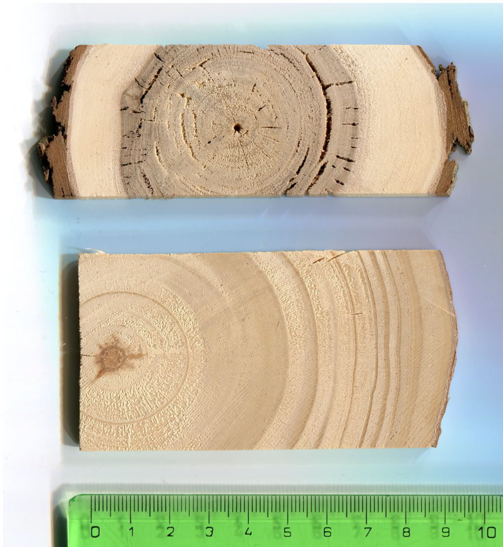
Obrázek 3.7: Vzorčky průřezu kmenem napadené vrby a průřezu kmenem borovice měřené pro 3. uspořádání.
