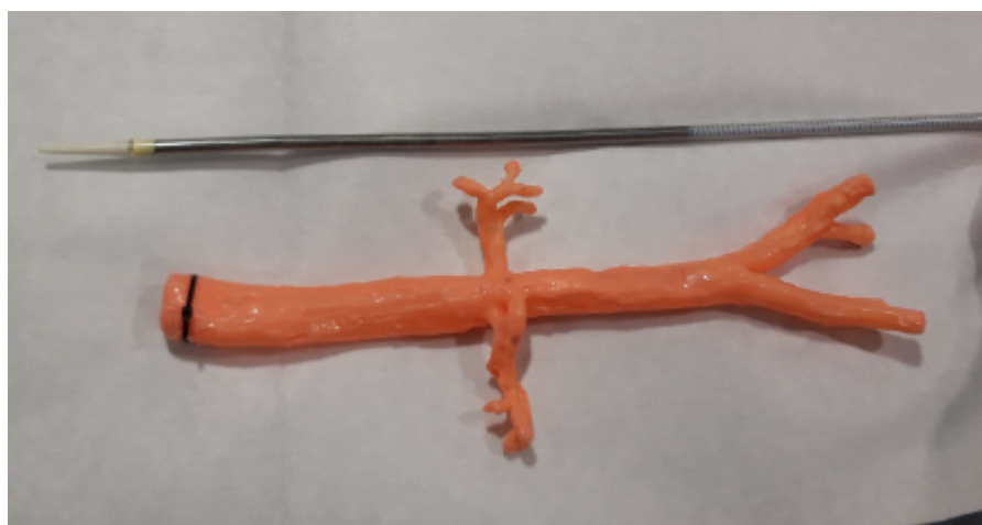
Obr. 4.7: Dutá aorta vytvorená zo silikónu Rebound 25.
