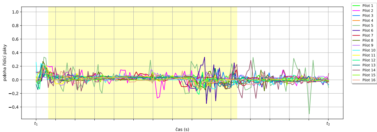
Obrázek A.36: Průběh v čase pro iluzi náklonu při prvním profilu - parametr Poloha řídicí páky v rovině roll).
