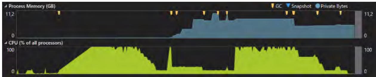
Obr. 5.6: Využitie operačnej pamäte s použitím metódy Math.NET na signále č.1 dlhom 20 000, ktorý sa skladá z hodnôt 1 až 1000.
