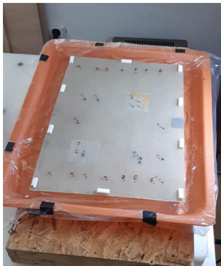
Obrázek 23 Sklolaminátový kompozit na hladině vodní nádoby
