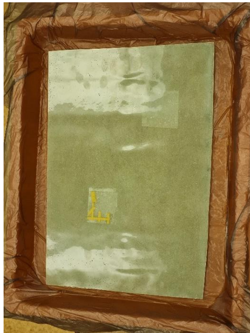
Obrázek 20 Vyrobený kompozit s defekty
