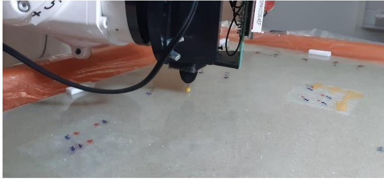
Obrázek 33 poloha koncovky při kontaktu s materiálem
